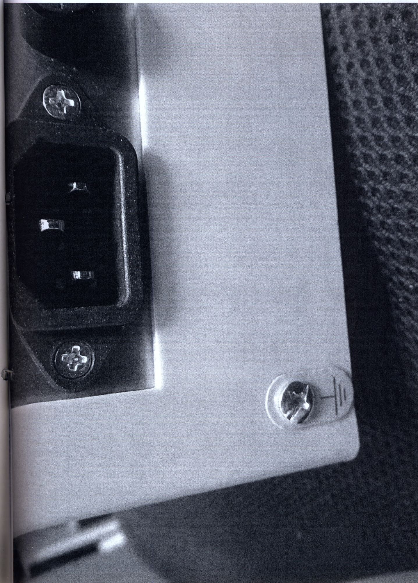
Рис. 12 – Маркировка клеммы заземления (земля) на корпусе центрифуги
