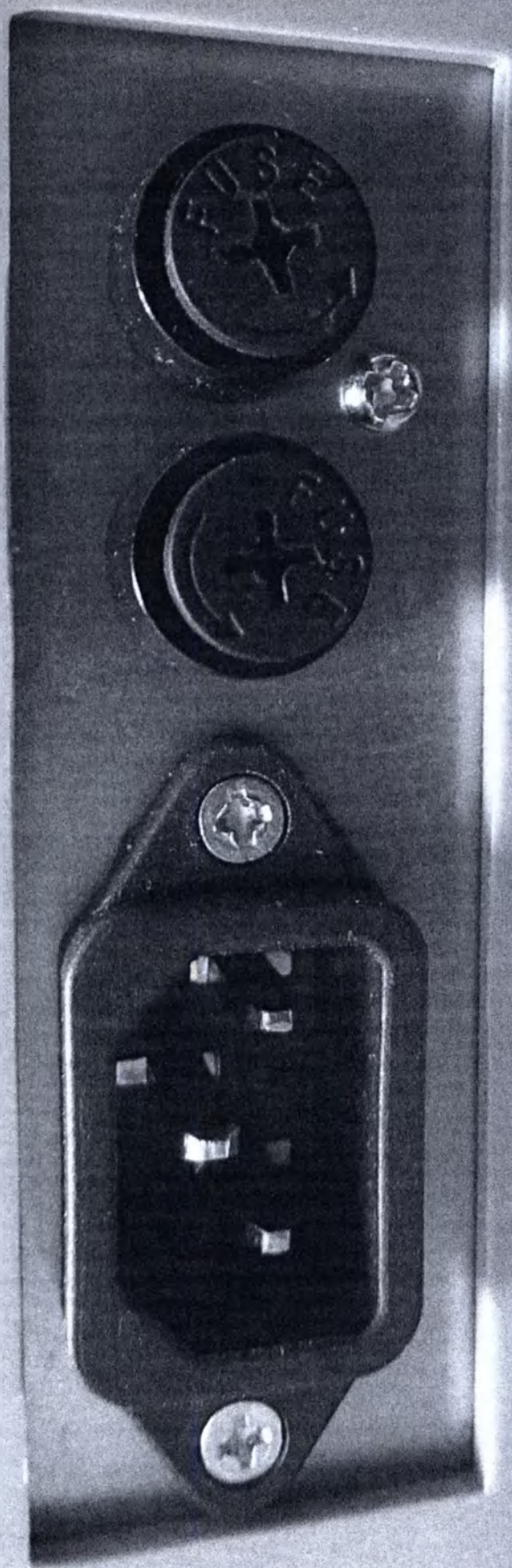
Рис. 51 – Клемма для соединения с источниками сетевого питания, держатель плавкого предохранителя и маркировка клеммы заземления (земля) на корпусе центрифуги
