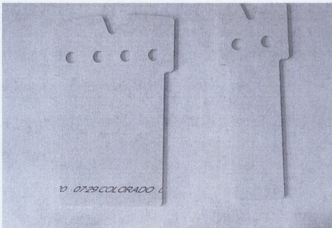
7. Крышка нагреваемого буферного лотка;
