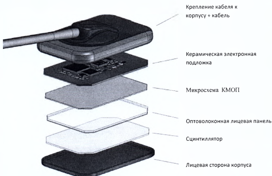
Рисунок 4 - Составные части датчика CR200
