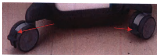
Рис. 37 Блокировочный механизм колесиков. Необходимо нажать ногой на элементы, выделенные стрелками, для блокировки движения стойки-тележки
