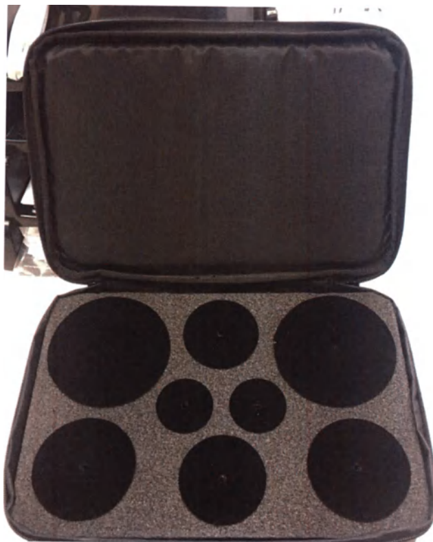
Рис. 17 Открытая сумка для электродов. Сумка для электродов открывается и закрывается с помощью вшитой молнии. В сумку вставлен вспененный полиэтилен для размещения электродов (в центре каждого черного круга из пены имеется специальное отверстие для вала электрода).
