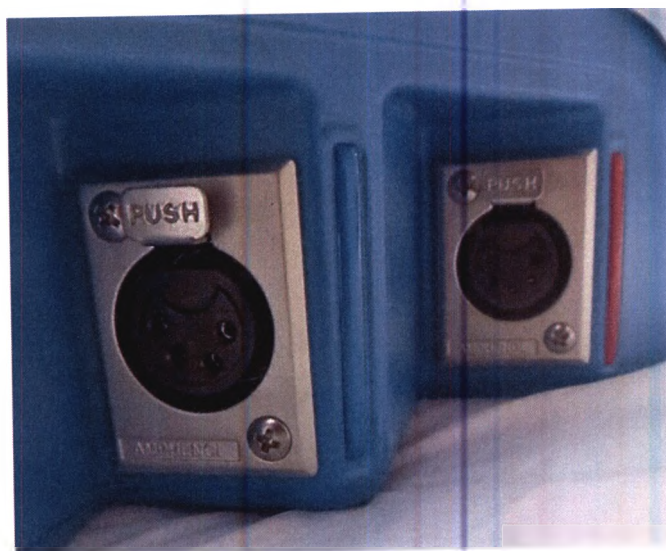
Рис. 11 Разъем для подключения рукояток для электродов. Рядом с каждым разъемом находится определенный цвет: «синий» - данный разъем предназначен для рукоятки изогнутой для электрода RES (на рукоятке есть ободок синего цвета в качестве подсказки оператору), «красный» - данный разъем предназначен для рукоятки изогнутой и прямой для электрода CAP (на рукоятке есть ободок красного цвета в качестве подсказки оператору). Для того чтобы извлечь разъем для подключения к аппарату от самого аппарата, необходимо нажать на верхнюю кнопку «PUSH».
