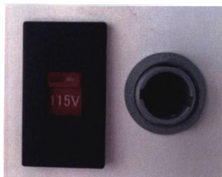
Рис. 32 Переключение напряжения на задней стороне стойки-тележки и разъем для соединения блока основного со стойкой-тележкой
