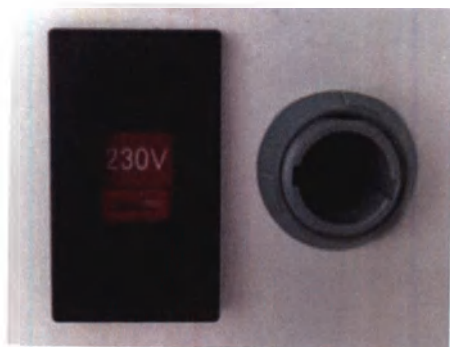
Рис. 32 Переключение напряжения на задней стороне стойки-тележки и разъем для соединения блока основного со стойкой-тележкой
