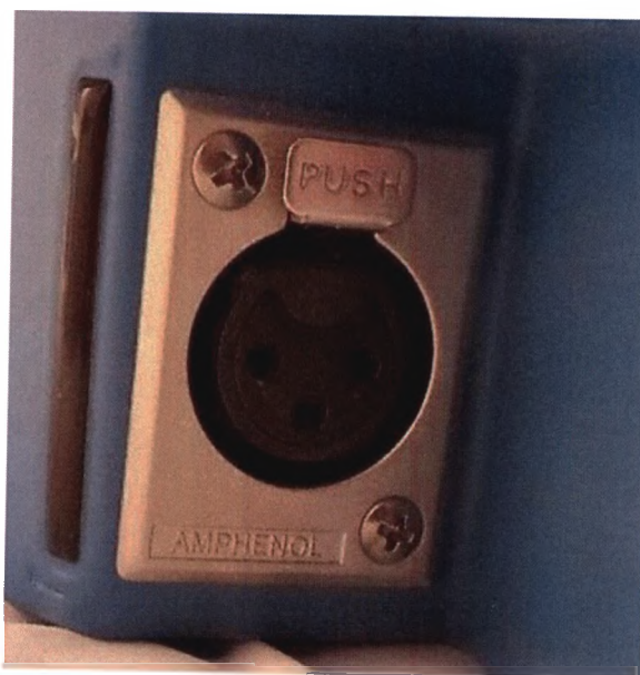
Рис. 9 Разъем для подключения возвратного плоского и цилиндрического электродов. Для того чтобы извлечь разъем для подключения к аппарату от самого аппарата, необходимо нажать на верхнюю кнопку «PUSH»
