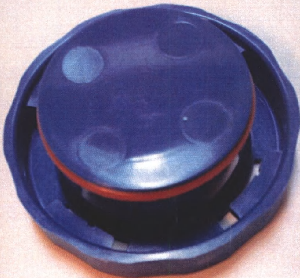
Фото 5 – Крышка смешивающей камеры
