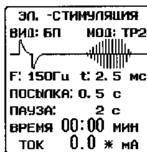
Рис. 10. Меню установки параметров метода «Электростимуляция» для прямоугольных импульсов (1) и экспоненциальных типа E2 (2).
