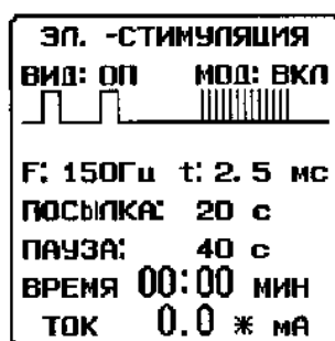
Рис. 10. Меню установки параметров метода «Электростимуляция» для прямоугольных импульсов (1) и экспоненциальных типа E2 (2).
