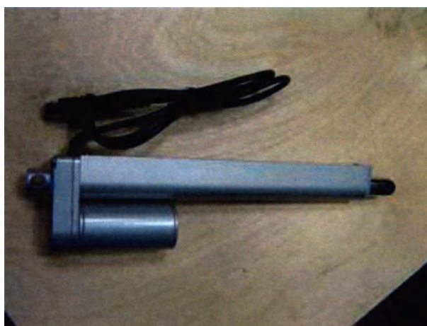
1.11 Автоматический подъемник дозкалибратора
