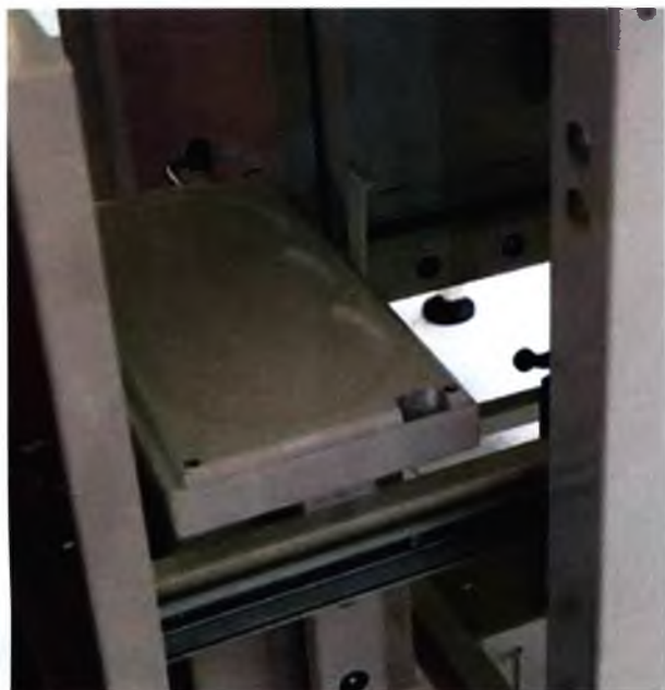
1.13 Автоматический подъемник для генераторов технеция
