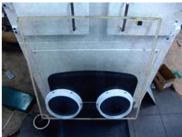
1.7 Защитная панель из плексигласа с двумя перчаточными проемами
