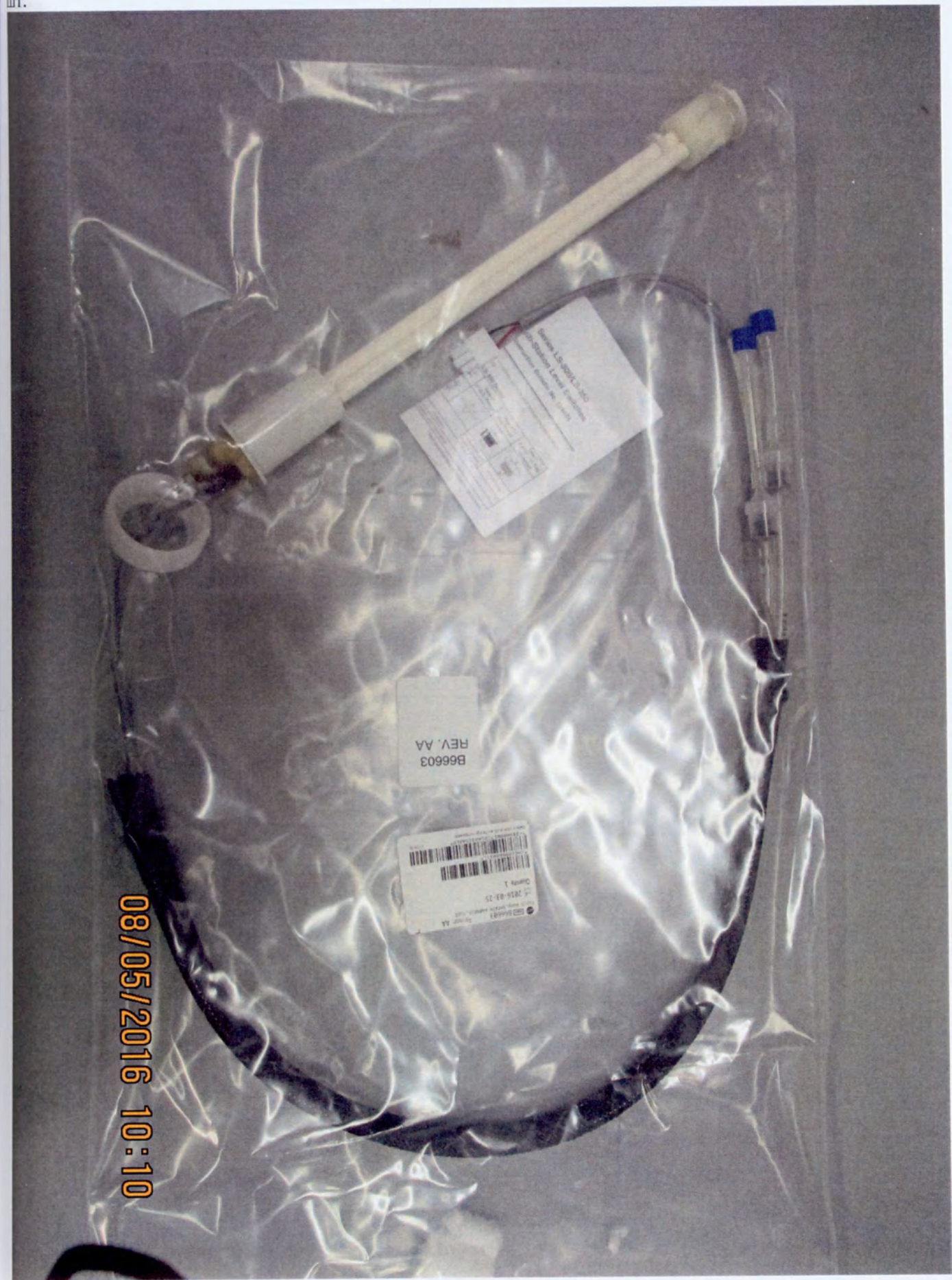
Фотография 18.1 – Сборка трубок и кабелей с датчиком уровня жидкости для изотонического раствора, в составе: Кабель – 1 шт.; Датчик уровня жидкости для изотонического раствора – 1 шт.; Трубка – 5 шт.
