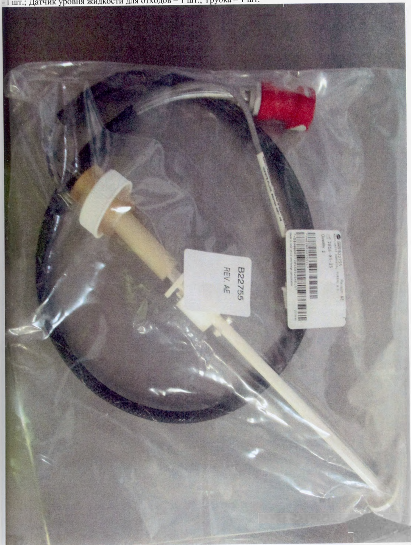
Фотография 19.1 – Сборка трубок и кабелей с датчиком уровня жидкости для отходов, в составе: Кабель – 1 шт.; Датчик уровня жидкости для отходов – 1 шт.; Трубка – 1 шт.
