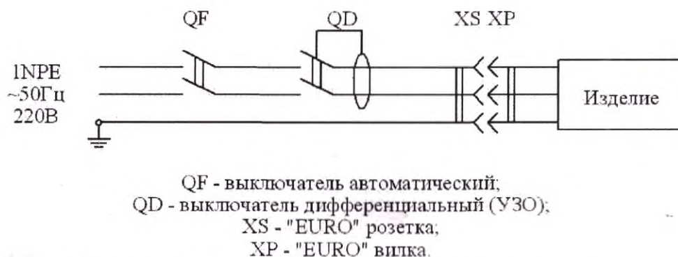
Рис. 2. Схема подключения изделия к электросети.
