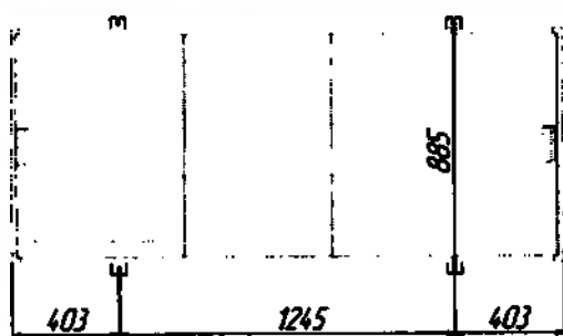
Вариант 1 – расположение уголков крепления к потолочному перекрытию
