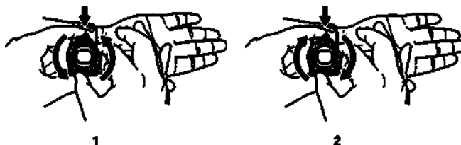
Figura 3. Uso del botón giratorio para ajustar la presión.
