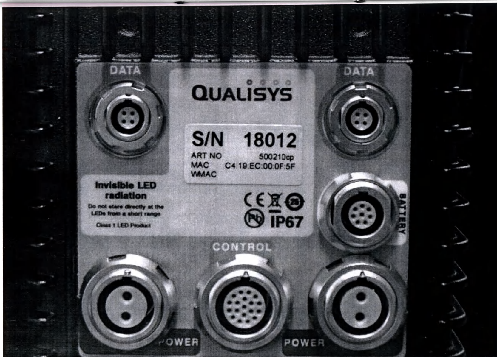
Инфракрасная высокоскоростная камера 210c+. Вид сзади.
