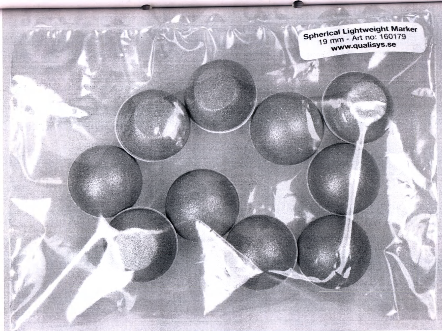
Пассивные маркеры сферические, диаметр 19 мм.
