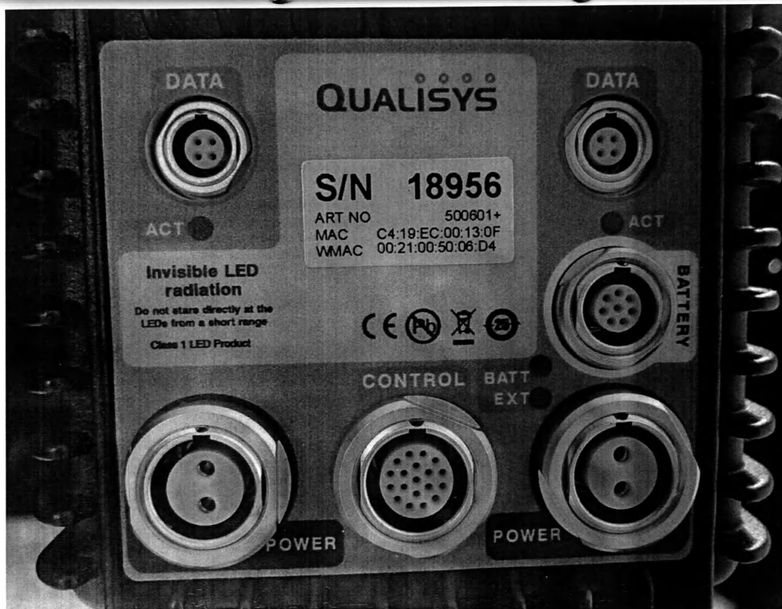
Инфракрасная высокоскоростная камера 601+. Вид сзади.
