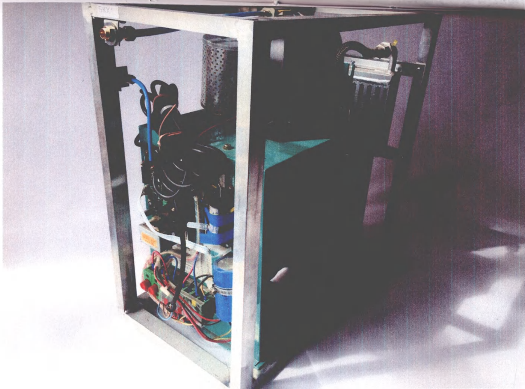
Рисунок 9 – Блок компрессоров концентратора
