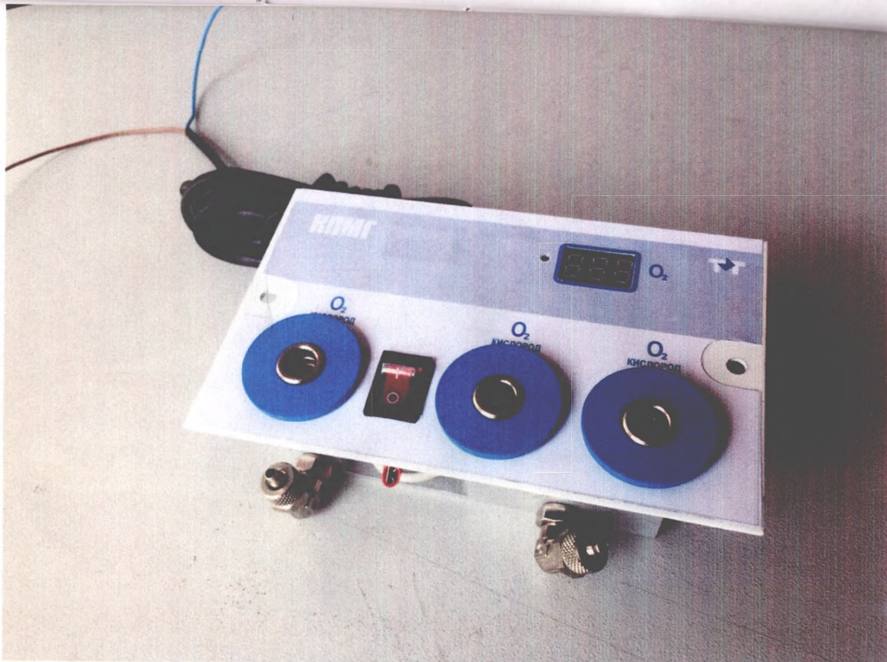
Рисунок 20 – Коллектор с тремя розетками на O 2 , с индикацией и шнуром питания
