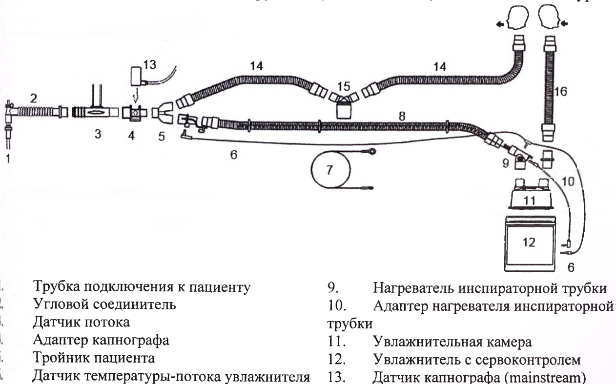
Рисунок 6 - Схема соединений однотрубного (коаксиального) дыхательного контура
