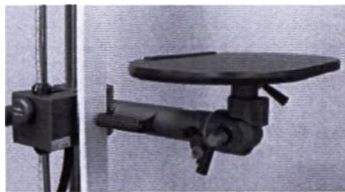
Рисунок 130. Крепление нижней полки к ВОК
