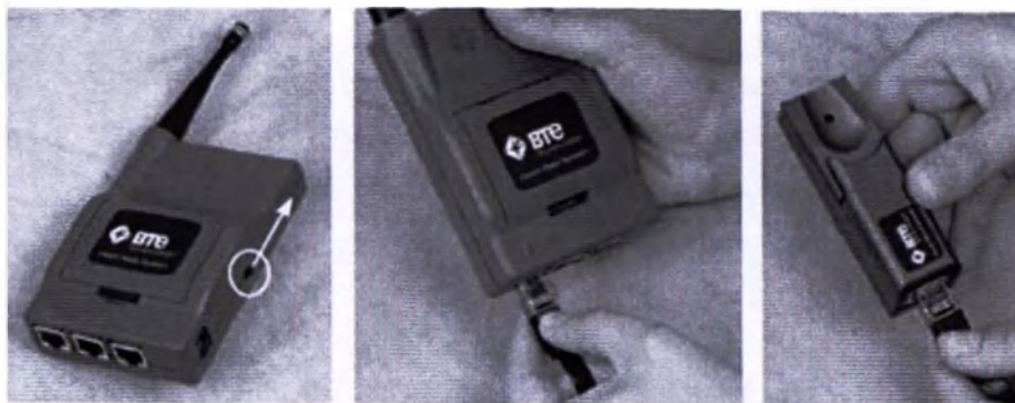
Рисунок 212. Соединение прибора с панелью переносной
