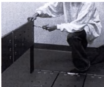
Рисунок 11. Прикручивание панели 6 и завершение сборки
