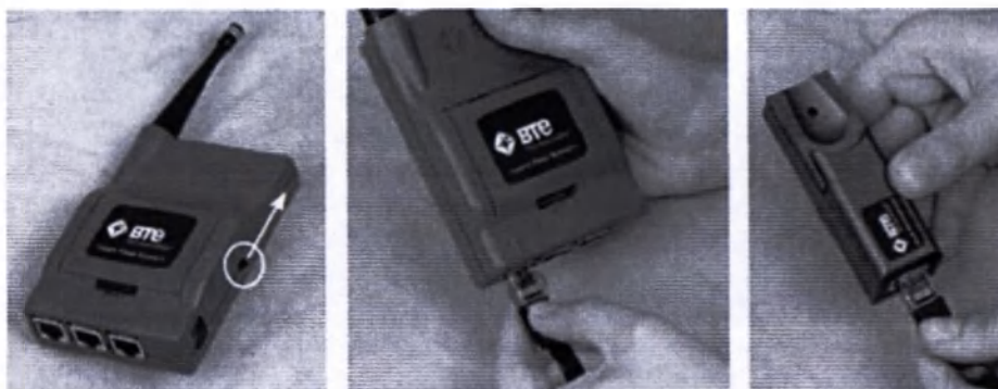
Рисунок 23. Соединение прибора с панелью переносной
