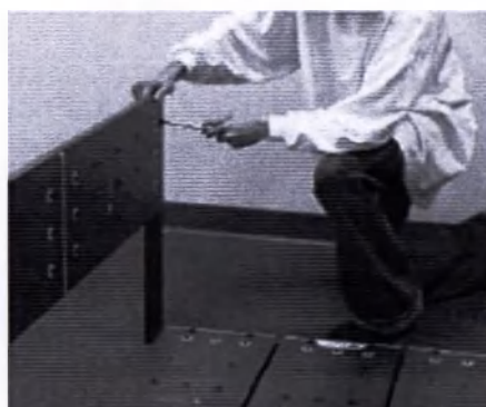
Рисунок 200. Прикручивание панели 6 и завершение сборки
