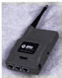
Рисунок 210. Крепление антенны (Панель переносная коммутационная)
