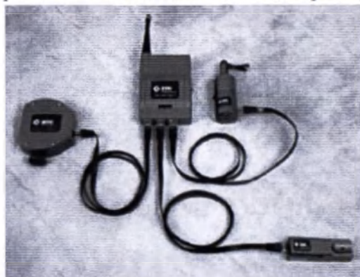
Рисунок 24. Подключение приборов к панели переносной
