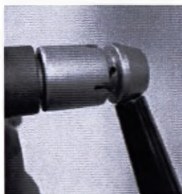
Рисунок 110. Выдвижная ручка в разблокированном положении
