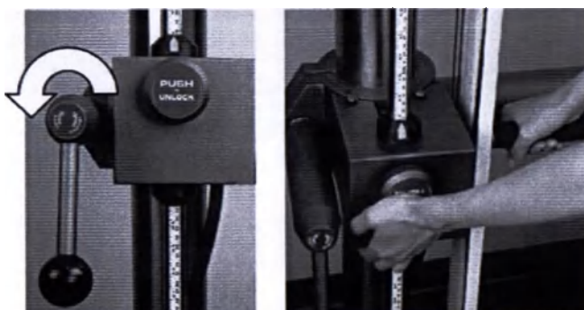
Рисунок 90. Ослабление блокирующего устройства и разблокировка рычага
