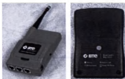
Рисунок 21. Панель переносная коммутационная, Bluetooth-модуль набедренный
