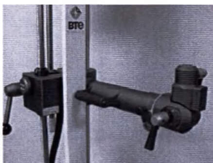
Рисунок 129. Крепление ВОК к рычагу колонки
