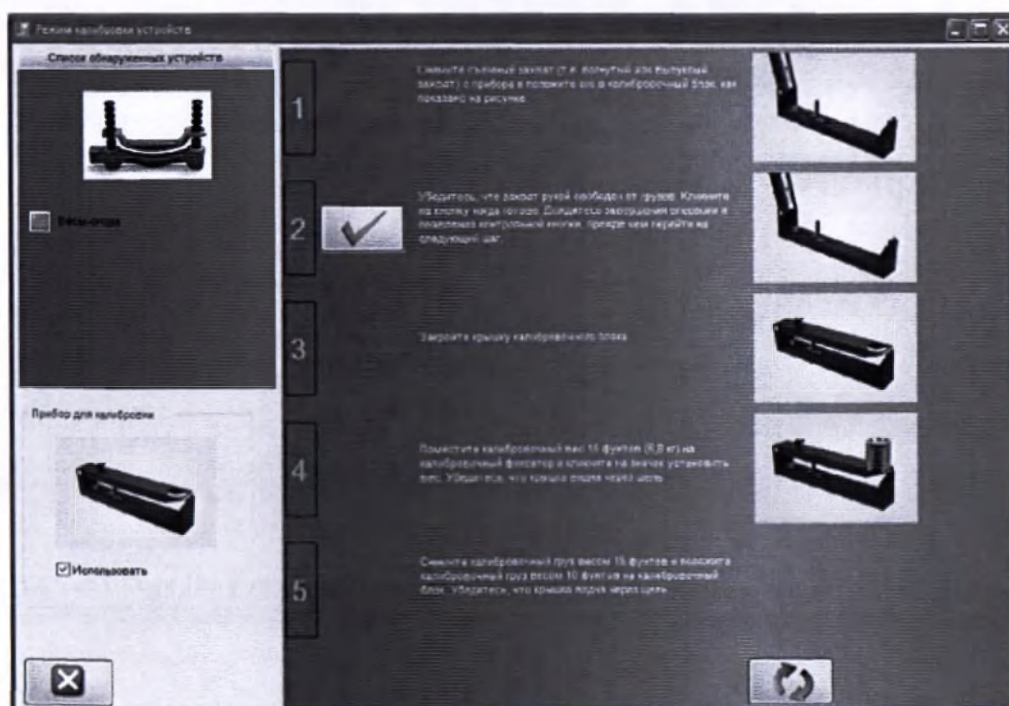
Рисунок 56. Калибровочный экран для Динамометра силы сжатия руки
