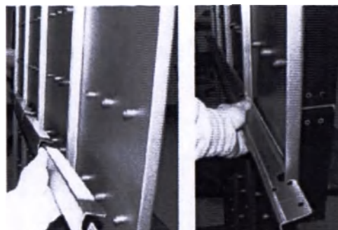
Рисунок 205. Расположение скобы задней и прикрепление ее к ДФД
