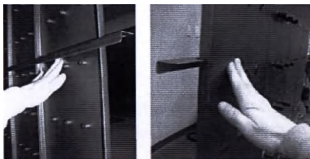
Рисунок 17. Прикрепление скобы задней к панелям 1-4
