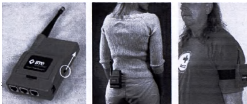
Рисунок 29. Переключатель панели и панель прикрепленная сзади пациента или на его левой руке
