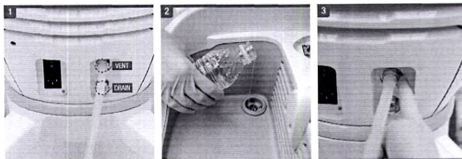
Рисунок 4.5. Заполнение водой контейнера основного блока
