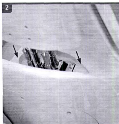
Совместите разъемы обоих компонентов и плотно нажмите вниз, пока не услышите щелчок.
