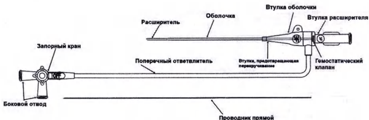
Рисунок 7. Структура изделия: Интродьюсеры IVA, стерильные, одноразовые, в варианте исполнения, короткие: 1. Оболочка; 2. Расширитель; 3. Втулка оболочки; 4. Втулка расширителя; 5. Гемостатический клапан; 6. Втулка, предотвращающая перекручивание; 7. Поперечный ответвитель; 8. Проводник прямой; 9. Предохранитель проводника (см. рис. 5); 10. Игла (см. рис. 5).
