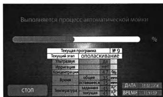
Рис. 8.12. Экранная форма процесса автоматической мойки
