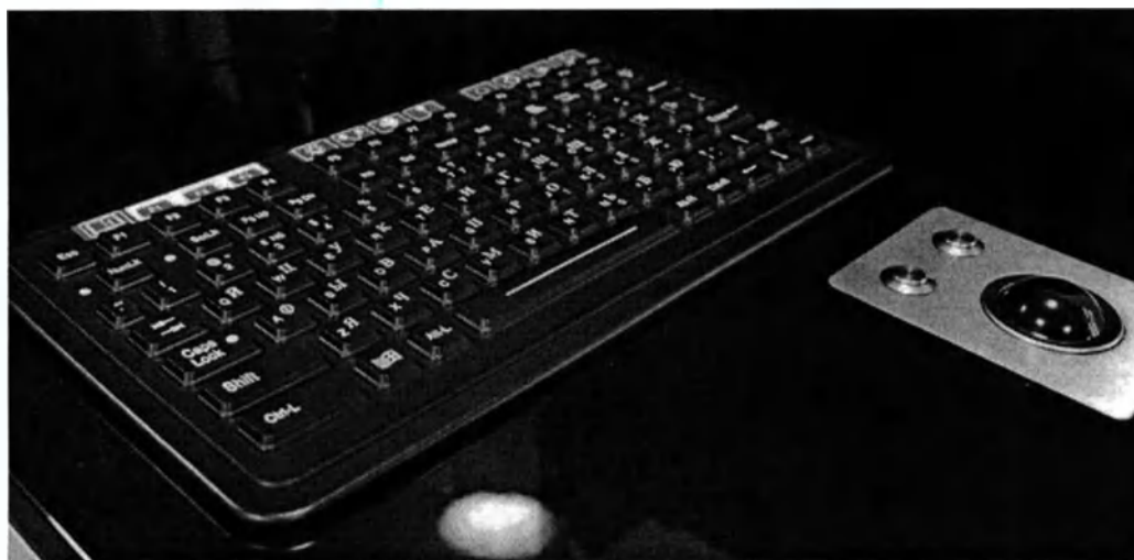
Рис. 4. Клавиатура и трекбол, интегрированные в верхнюю крышку основного блока
