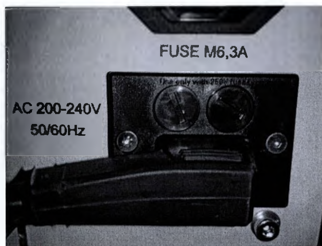
Рис.21. Место расположения предохранителей
