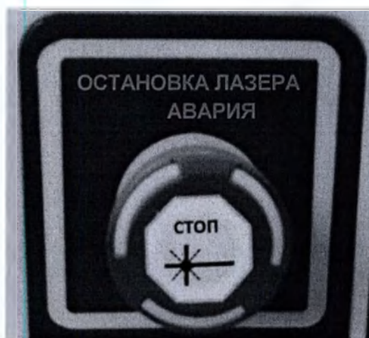
Рис. 8. Кнопка «СТОП» аварийного отключения Установки
