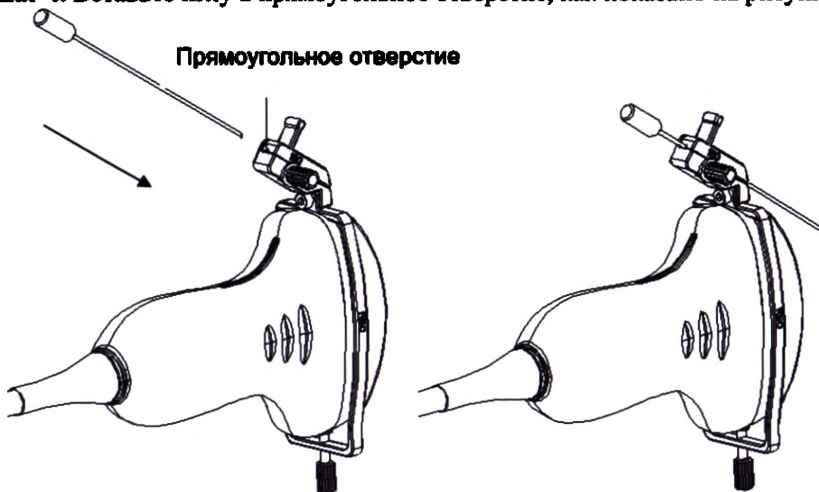
Рисунок 11.18. Вставка иглы в прямоугольное отверстие
