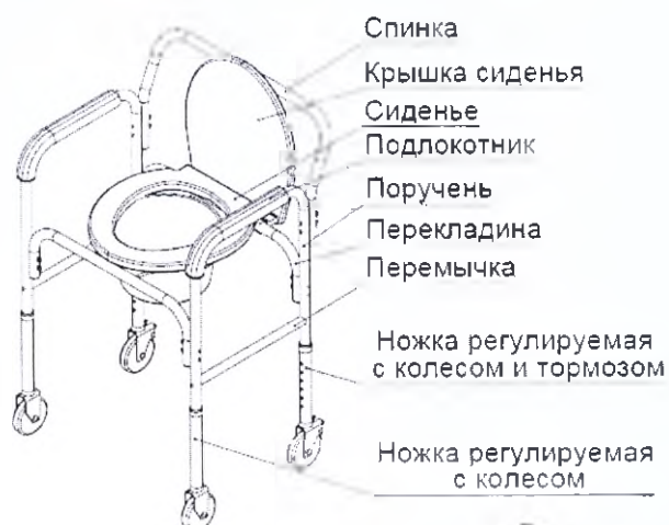
Рисунок 21 - Общий вид кресла-стула с санитарным оснащением на колесах KM21.1.
