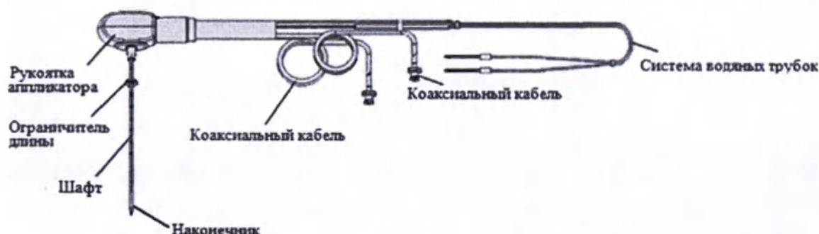
Рисунок 5. Аппликатор микроволновой абляции с двумя стержнями
