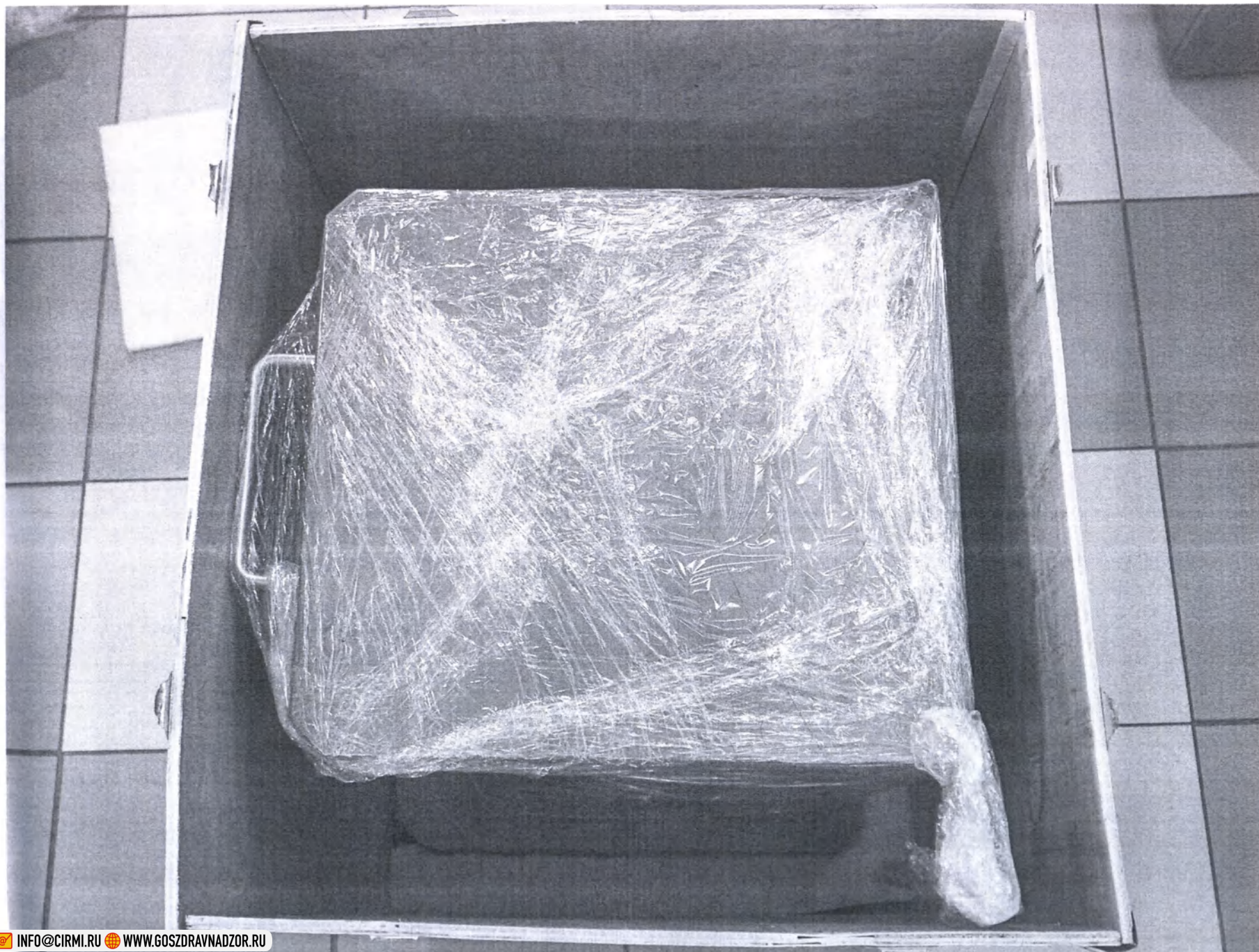
Рис. 12. Упаковка мобильной стойки (тележки) в транспортную тару (деревянный ящик)
