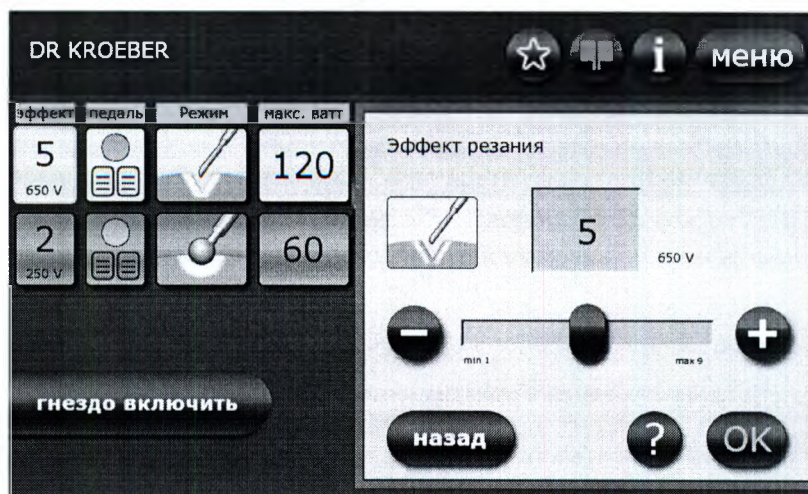
Рис. 5-9 Эффект. монополярное резание
