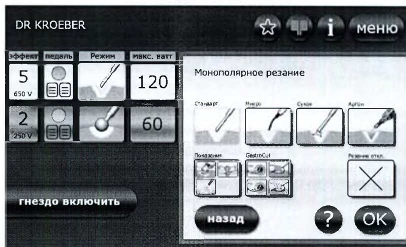
Рис. 5-7: Режимы монополярного резания
