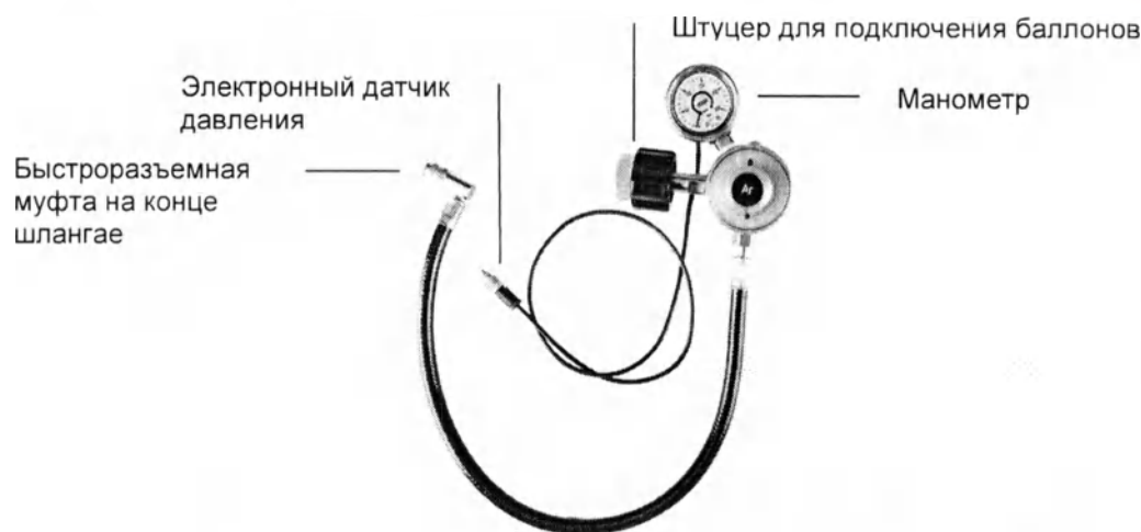
Рис. 2-2: Редуктор с электронным датчиком давления
