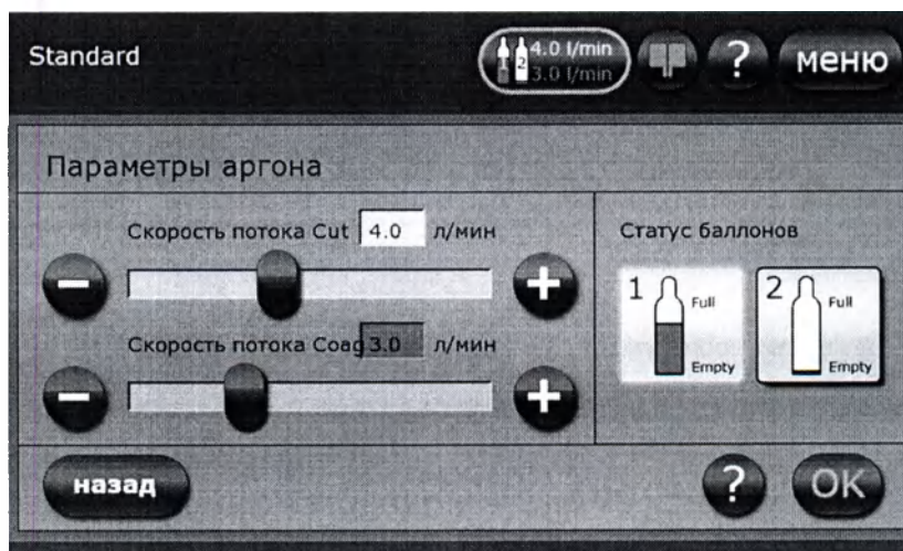
Рис. 5-3: Индикатор уровня заполнения на дисплее аппарата ARC 400 5
