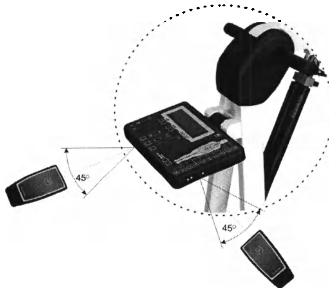
Рисунок 8 – Положение устройства включения относительно датчика сигналов
