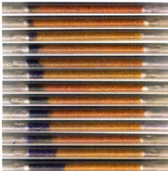
Окрашивание после пропускания через индикаторную трубку воздуха ротовой полости, свидетельствующее об образовании аммиака
