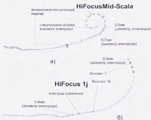
Рисунок 3 – варианты исполнения электродов:
