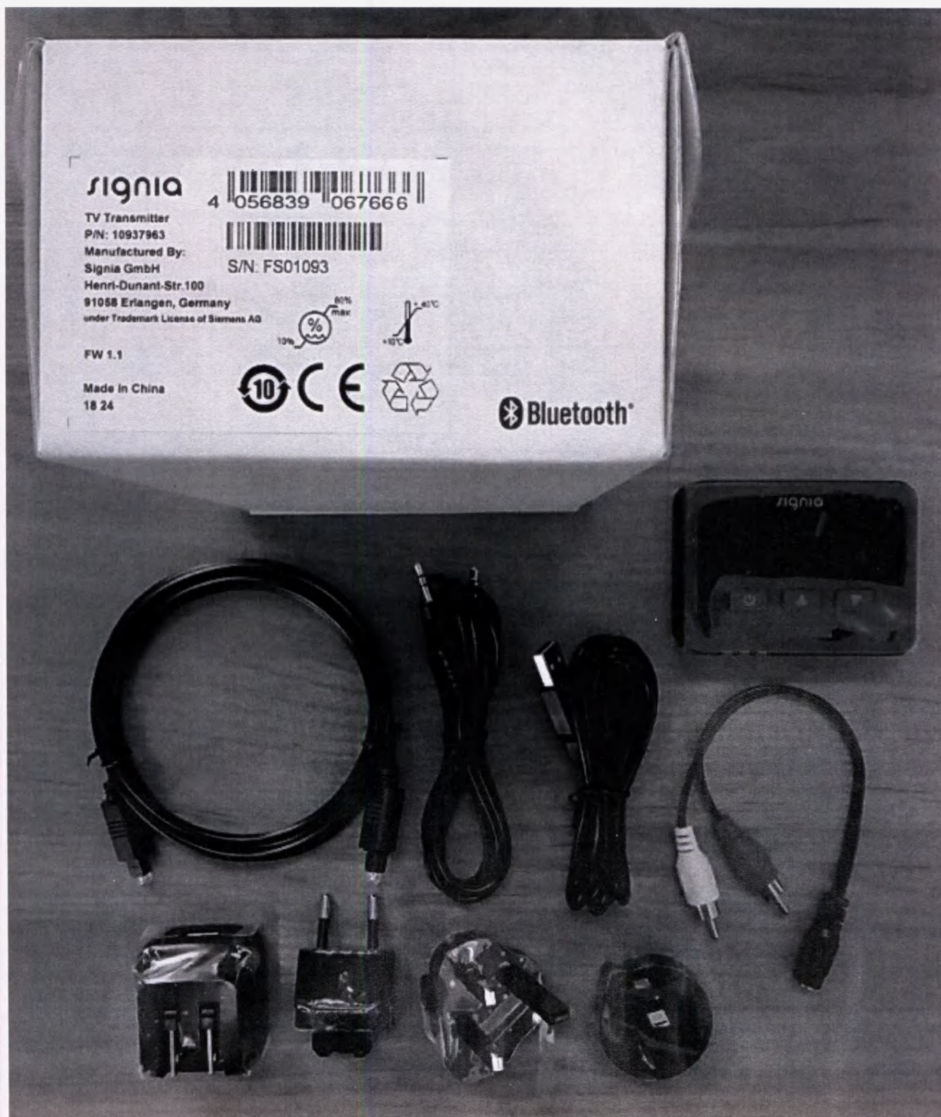
Беспроводной передатчик TV Transmitter в комплекте: основной блок TV Transmitter, кабель TOSLINK, переходник RCA, USB-провод, сетевые адаптеры (4 шт.), аудиокабель
