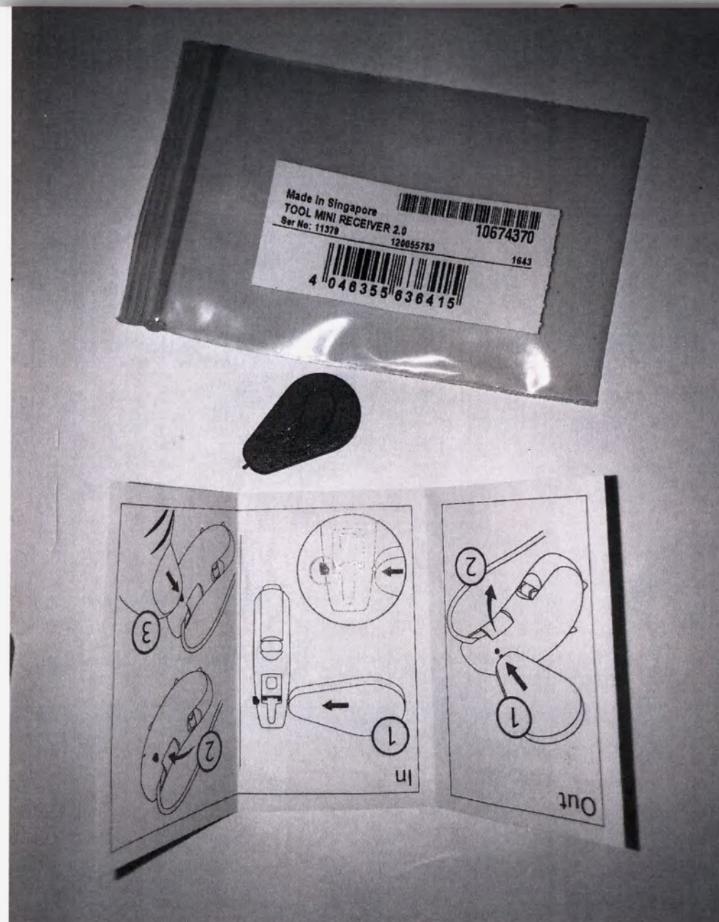
Вспомогательный инструмент для снятия мини-ресивера (TOOL MINI RECEIVER 2.0).
