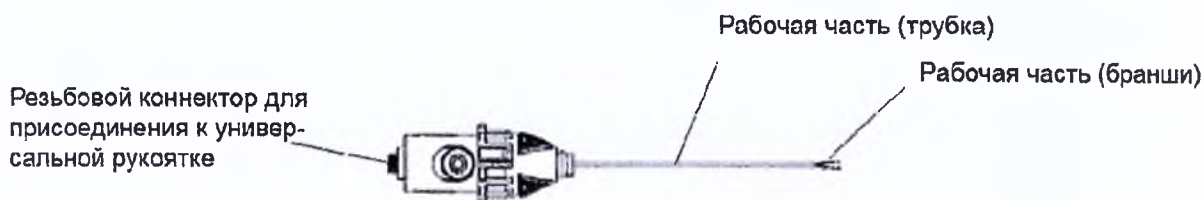
Рис. 4 - Схема конструкции пинцетов-наконечников офтальмологических стерильных, одноразовых.
