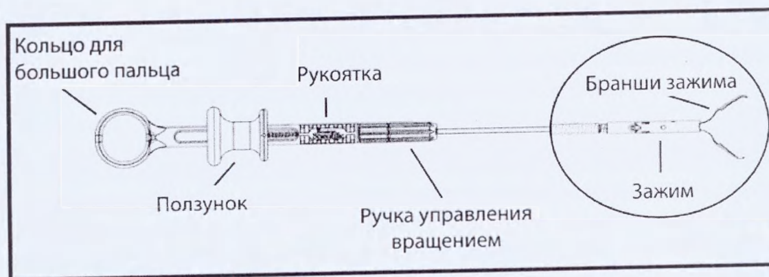
Рисунок 2. Раскрытие браншей зажима Resolution 360
