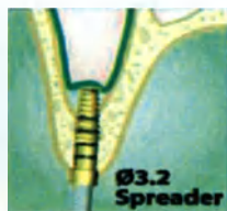
Фреза Spreader Ø3.2 Скорость сверления: 20 об. в мин. Сила закручивания: 40-45 Нсм
