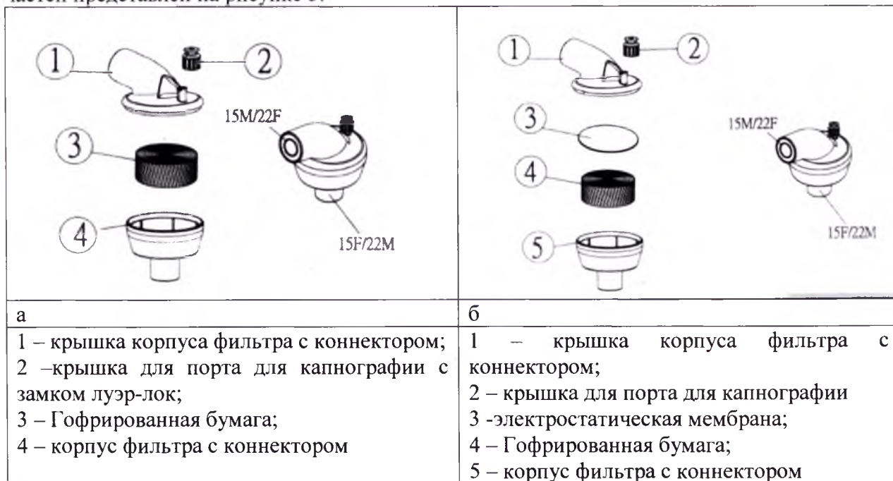
Рисунок 5 Фильтр дыхательный, теплооблагодобменный, с портом Луер-Лок, угловой, Ø 22F/15M, 22M/15F (a)
