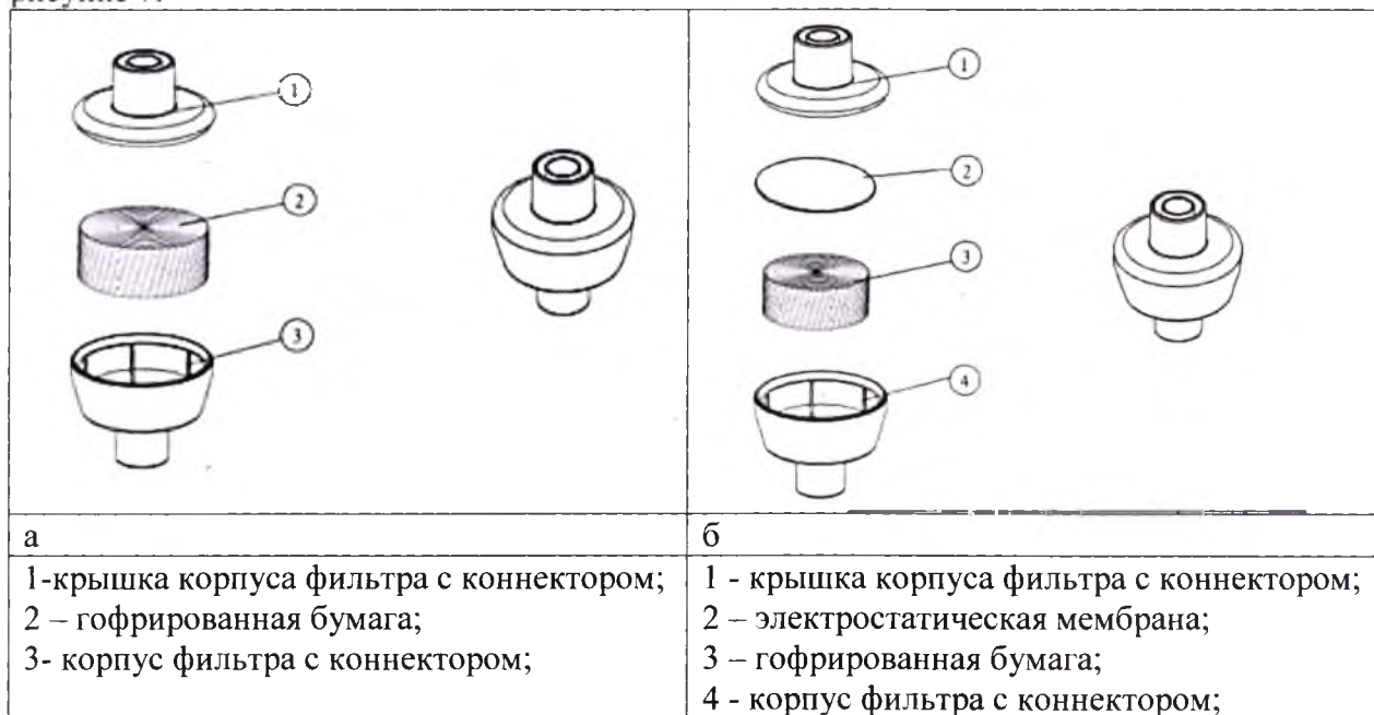
Рисунок 7 Фильтр дыхательный, теплооблагодобменный, без порта Луер-Лок, Ø 22F/15M, 22M/15F
