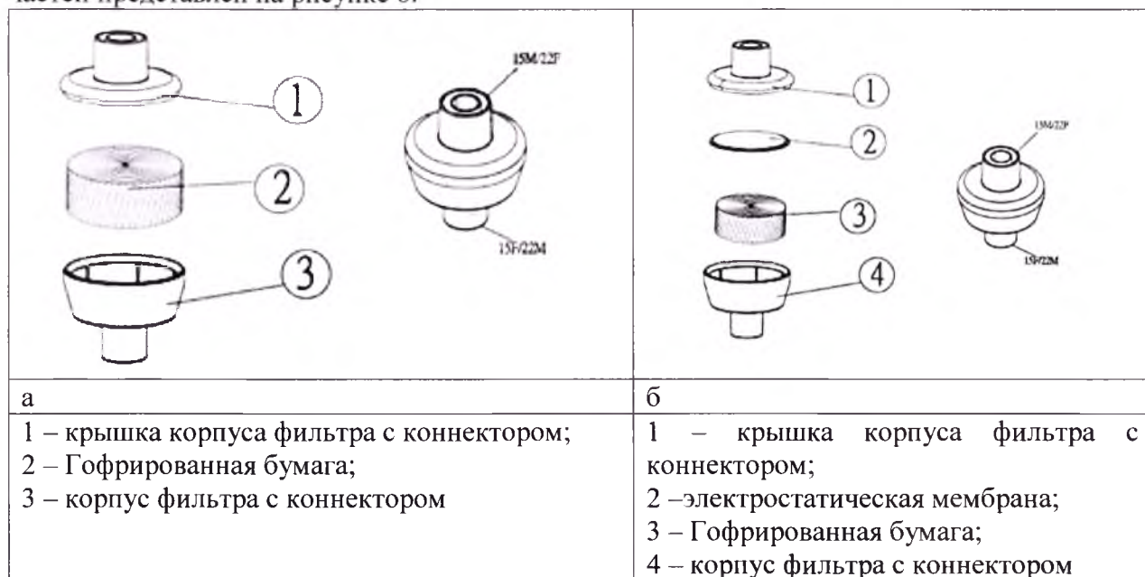
Рисунок 6 - Фильтр дыхательный, теплооблагодотменный, без порта Луер-Лок, Small, Ø 22F/15M, 22M/15F (а)
