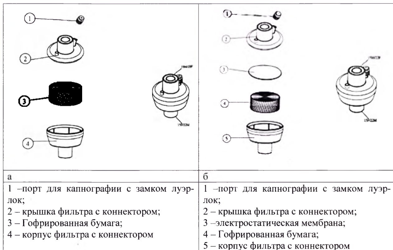
Рисунок 3- Фильтр дыхательный, тепловлагообменный, с портом Луер-Лок, Ø 22F/15M, 22M/15F(а)
