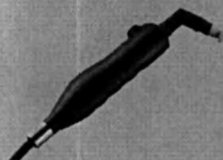
Датчик тимпанометра с соединительным кабелем
