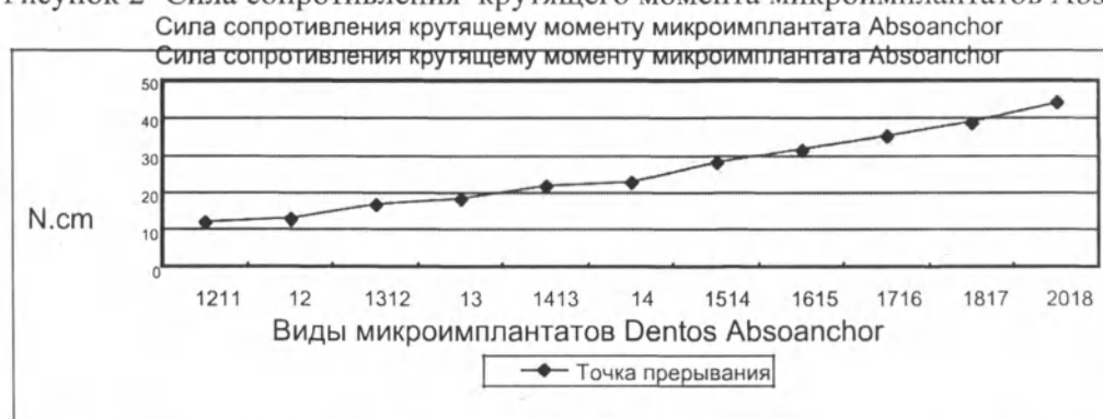
Рисунок 2- Сила сопротивления крутящего момента микроимплантатов Absoanchor
