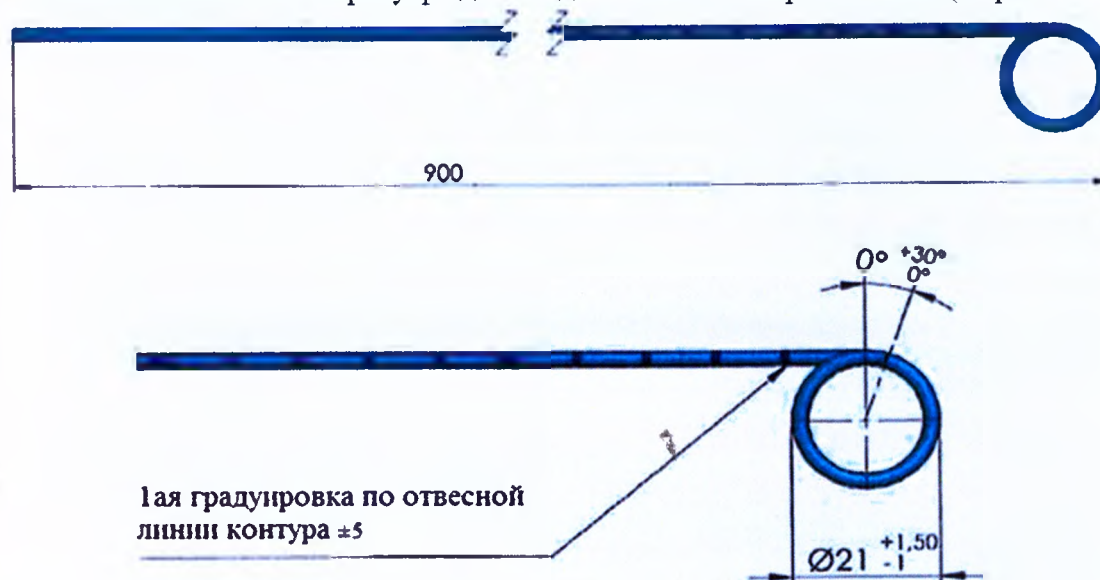
Рисунок 4 - Габаритные размеры однопетлевого мочеточникового стента
