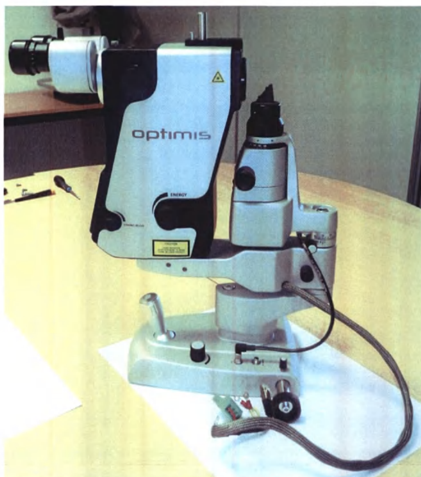
Рисунок 3. Лампа щелевая модели SL 9800 с призма-удерживающей головкой
