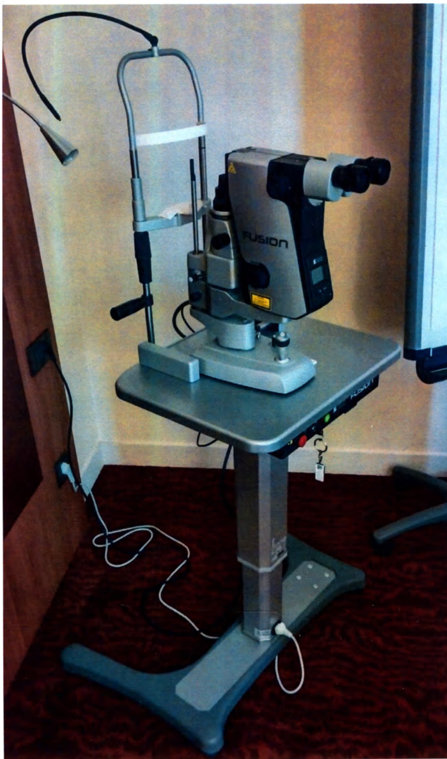
Рисунок 1 – Система офтальмологическая лазерная OPTIMIS Fusion с лампой щелевой модели SL 9800 с призма-удерживающей головкой.
