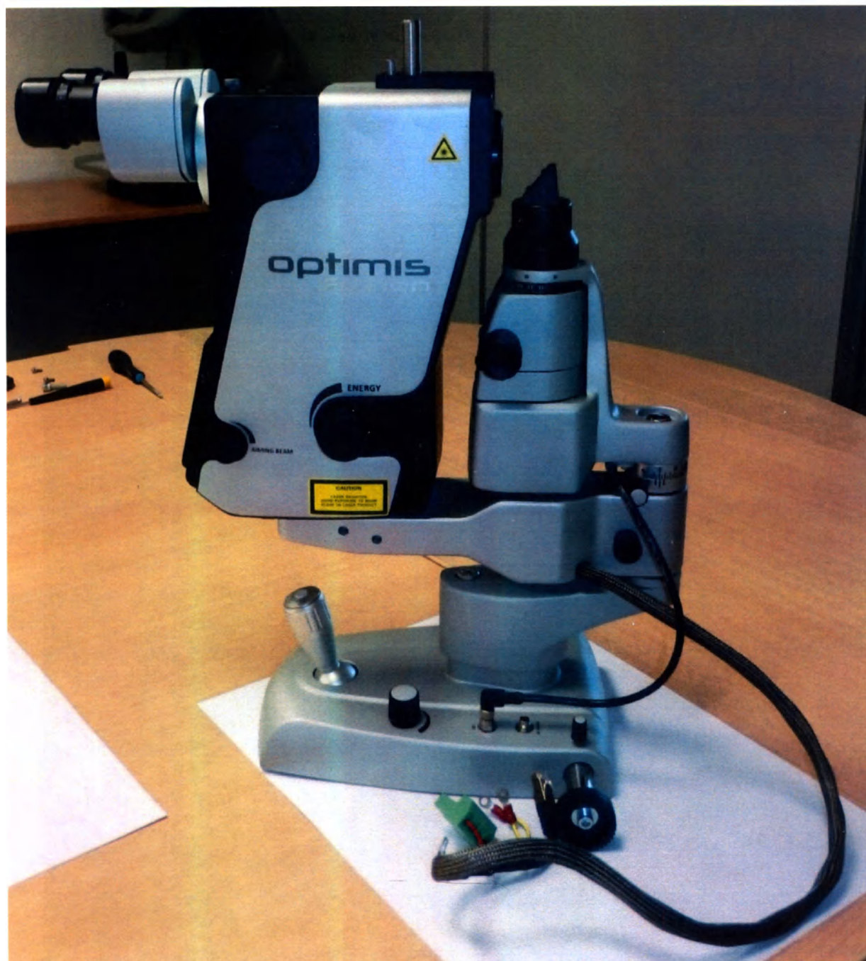
Рисунок 6 – Лампа щелевая с принадлежностями модели SL 9800 с призма-удерживающей головкой.
