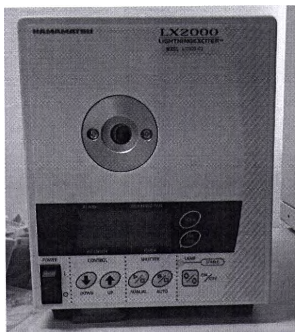
Рисунок 3.12 – Блок осветителя для модуля формирования флуоресцентных изображений LX2000 (вид спереди)
