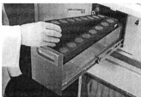
Рис.27 Замена угольных фильтров
