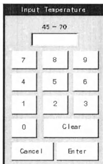
Рис. 67 Настройка температуры печи
