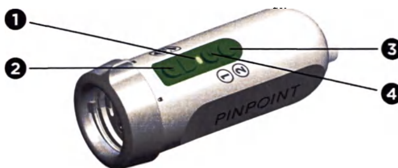
Рисунок 11. Органы управления и индикаторы на камере PINPOINT
