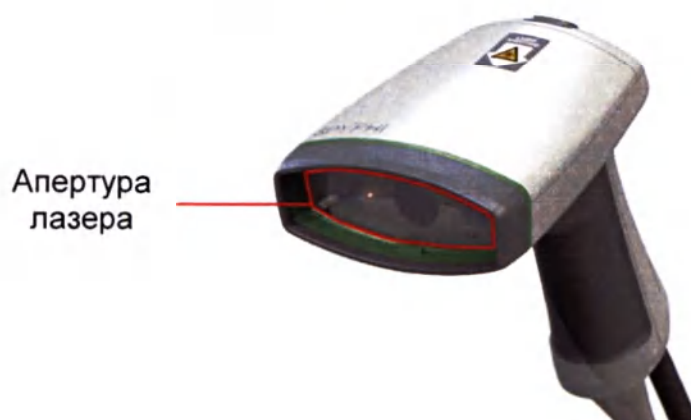
Рисунок 2. «Апертура лазера» (laser aperture) устройства для получения изображений SPY-PHI
