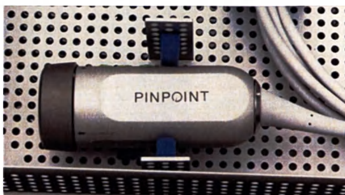
Рисунок 60. Крепление камеры PINPOINT и разъема
