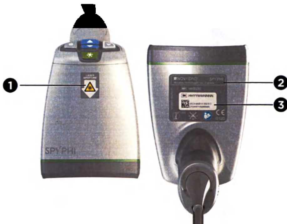
Рисунок 8. Общий вид мест расположения маркировки на устройстве для получения изображений SPY-PHI
