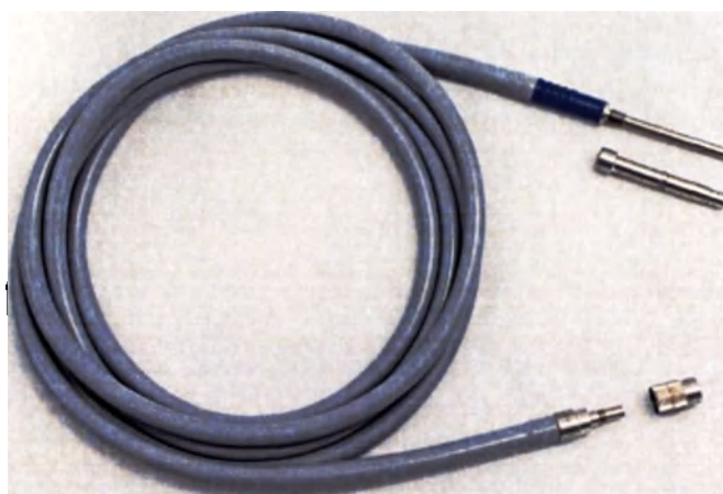
Рисунок 49. Удаление переходников со световодного кабеля
