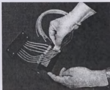
Рисунок 5-36. Установка на место маркировочной таблички трубок
