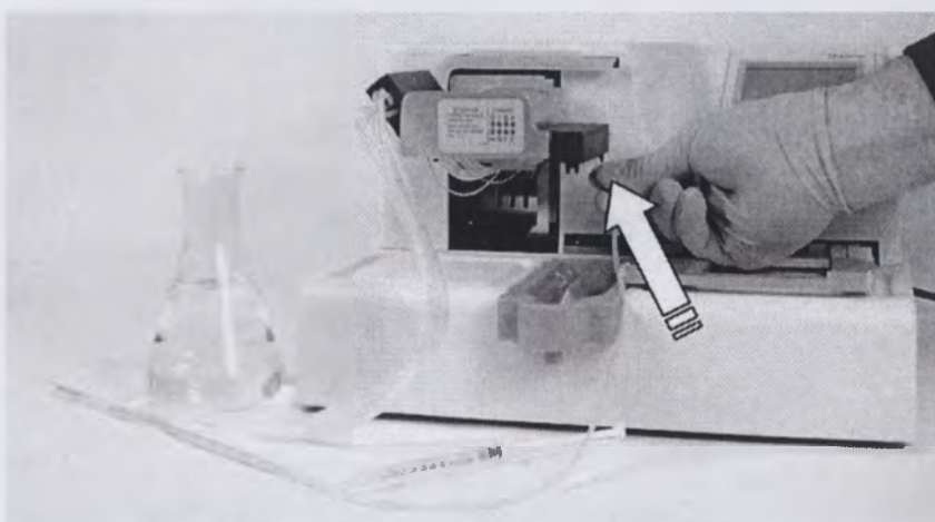
Рисунок 6-52. Установка трубки на наконечник канала А
