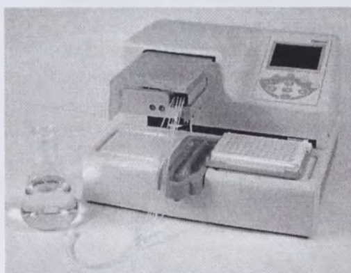
Рисунок 6-49. Стрипы 8 x 12, установленные на адаптер планшета
