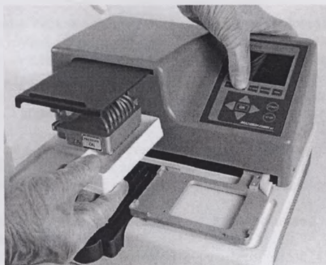
Рисунок 5-24. Очистка трубок с использованием лотка для реагента
