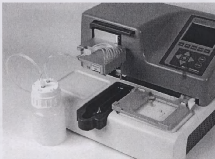
Рисунок 3-13. Резервуар для реагента, подсоединенный к прибору.
