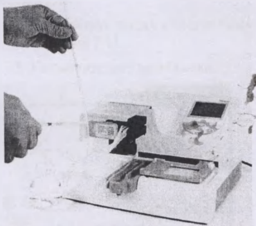
Рисунок 6-53. Установка уровня жидкости – сначала на нижней отметке, а затем на верхней отметке
