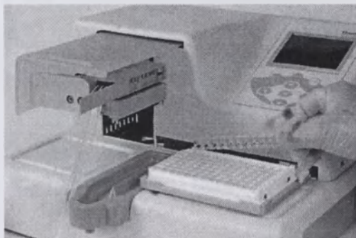
Рисунок 6-50. Удаление заполненного стрипа для взвешивания
