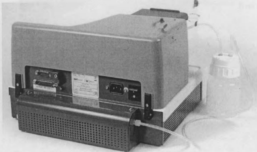
Рисунок 5-33. Место хранения транспортного фиксатора
