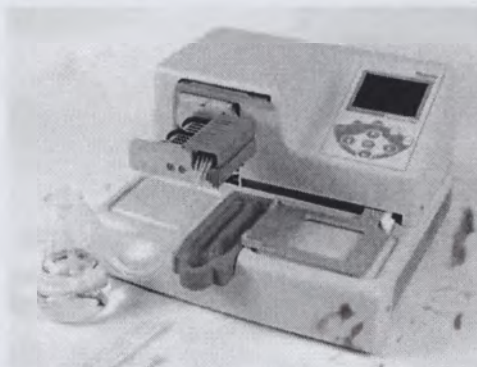
Рисунок 4-15. Правильное размещение всех трубок диспенсирующей кассеты
