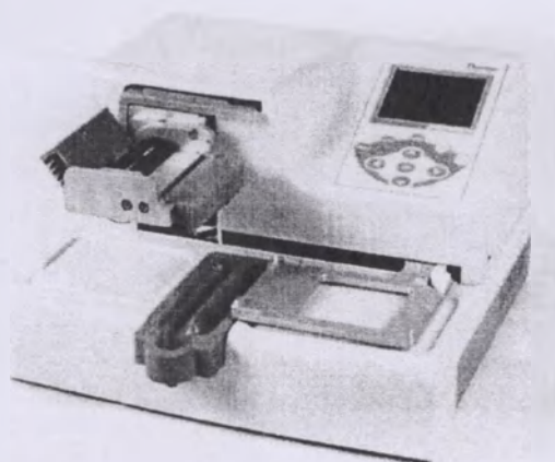
Рисунок 4-19. Положение покоя кассеты для диспенсирования.
