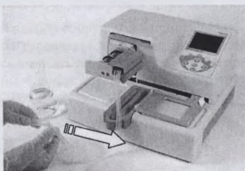
Рисунок 4-17. Удаление защитной утяжеляющей пластинки для трубок и резинового держателя
