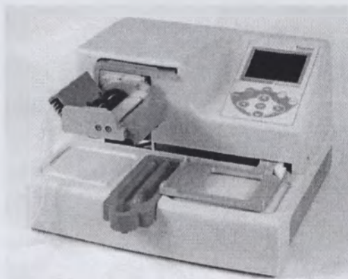
Рисунок 4-16. Снятие приспособления для защиты наконечников с кассеты для диспенсирования
