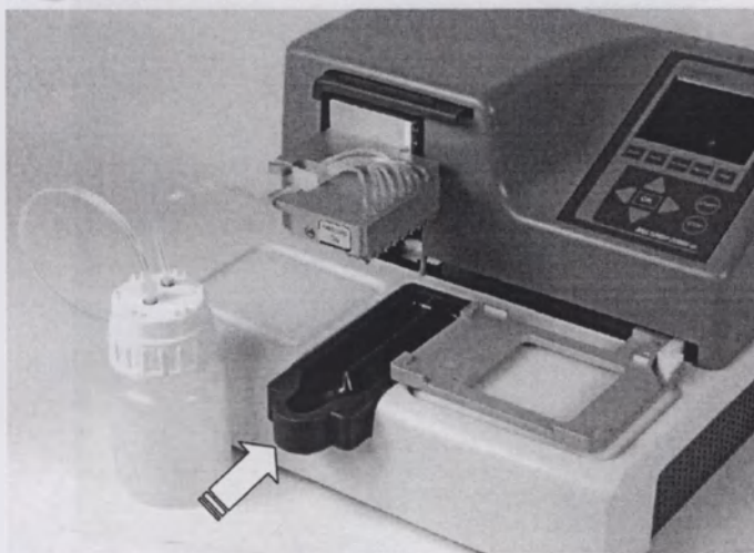
Рисунок 3-8. Установка заливочной емкости
