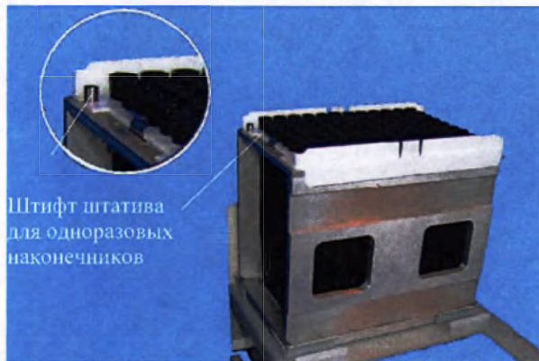
Рисунок 5.60: Штифт штатива для одноразовых наконечников
