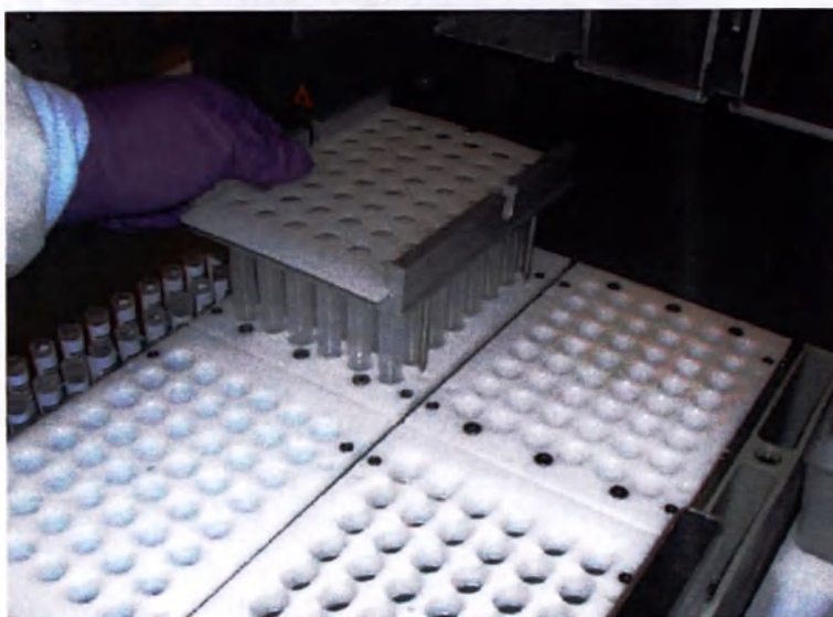
Рисунок 5.176: Загрузка держателя для подсистемы 1 мл в термостат-нагреватель 1
