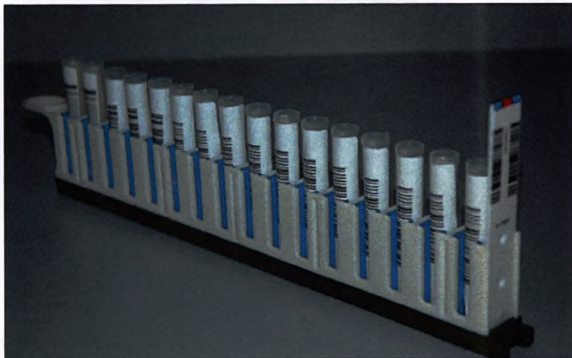
Рисунок 5.165: Штатив для пробирок с образцами (со штрих-кодом на правой стороне)
