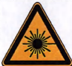
Рисунок 8.8: Предупреждающий знак лазерного излучения
