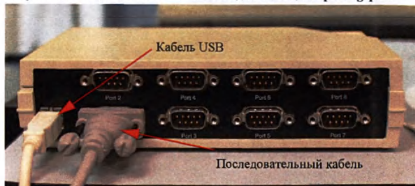
Рисунок 1.4: Подключение кабелей сзади USB-адаптера Edgeport™
