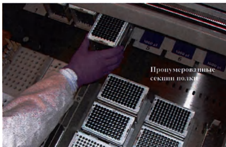
Рисунок 5.61: Загрузка одноразовых наконечников на пронумерованные секции полки, начиная со 2-й и заканчивая 8-й
