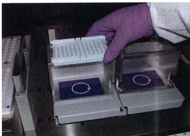
Рисунок 5.183: Лоток для одноразовых наконечников: Загрузка пустого лотка
