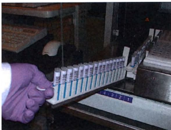
Рисунок 5.168: Загрузка штатива для пробирок с образцами на рабочий стол
