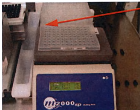
Рисунок 5.91: ПЦР-планшет на выходной платформе
