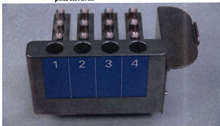
Рисунок 5.111: Позиции для пробирок для мастер-микса на держателе для кассет с амплификационными реагентами
