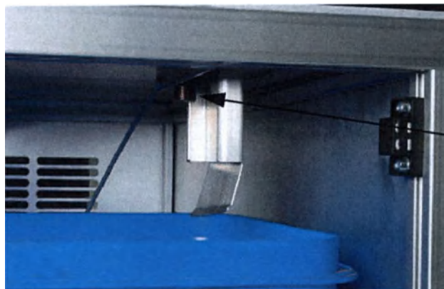
Рисунок 1.36: Детектор твердых отходов
