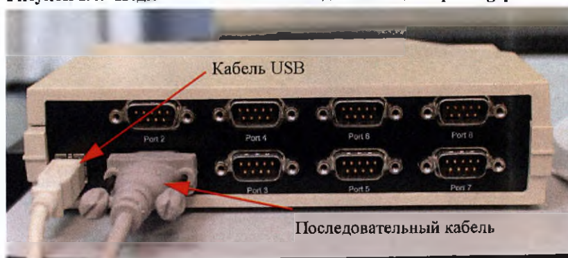
Рисунок 1.4: Подключение кабелей сзади USB-адаптера Edgeport™
