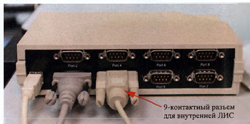
Рисунок 1.5: Дополнительное подключение ЛИС к порту 3 (COM5)
