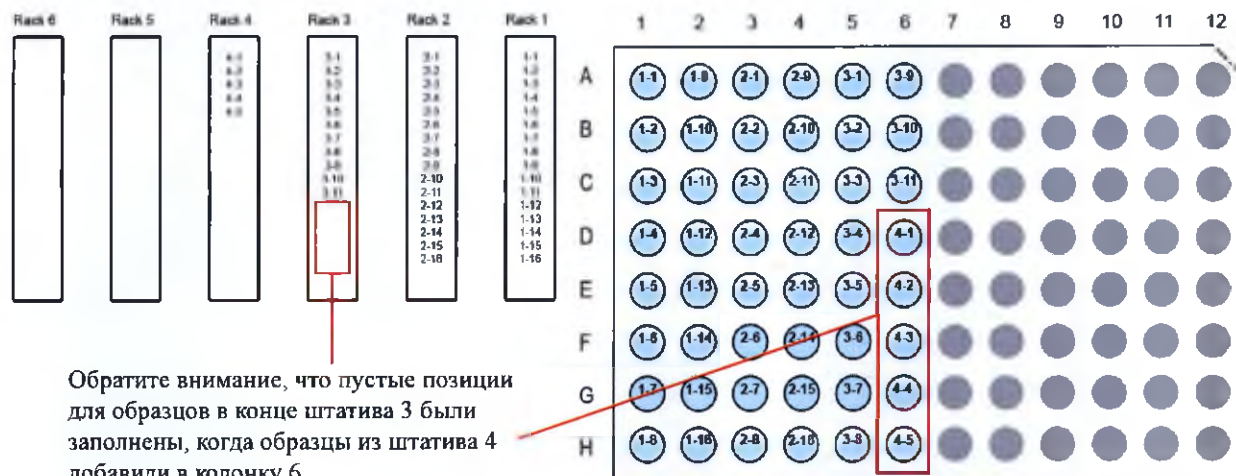
Рисунок 5.79: Схема планшета с 48 образцами на четырех штативах
