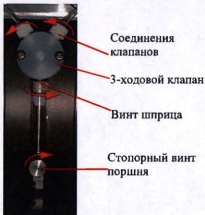
Рисунок 9.6: Устройство шприца
