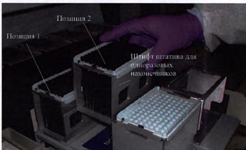
Рисунок 5.59: Загрузка штатива для одноразовых наконечников в держатель штативов для одноразовых наконечников, позиции 1 и 2
