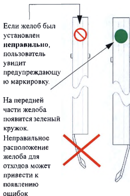
Рисунок 9.10: Правильное размещение желоба для отходов
