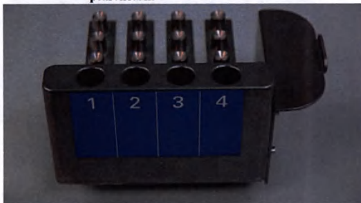
Рисунок 5.111: Позиции для пробирок для мастер-микса на держателе для кассет с амплификационными реагентами
