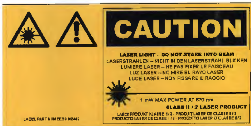
Рисунок 8.6: Предупреждающая этикетка лазерного излучения
