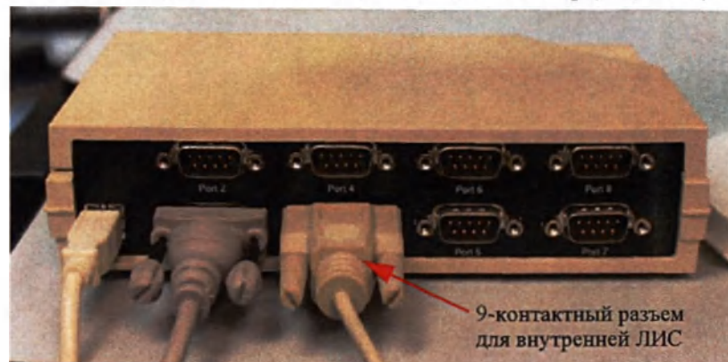
Рисунок 1.5: Дополнительное подключение ЛИС к порту 3 (COM5)
