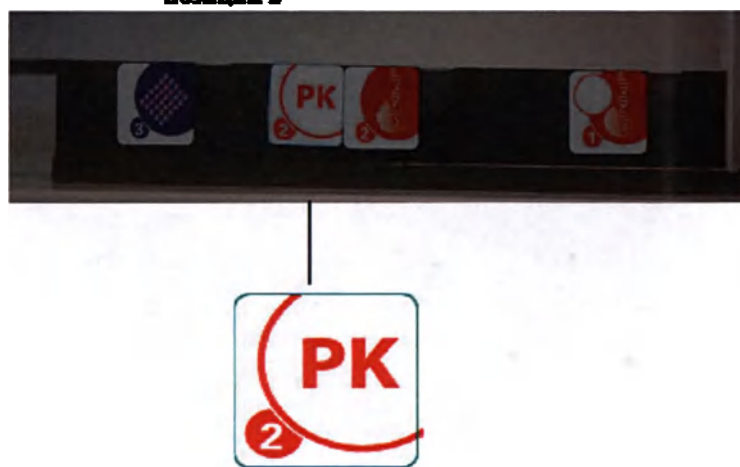
Рисунок 2.7: Держатель реагента № 1 с маркировкой РК на позиции 2
