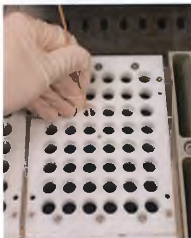
Рисунок 9.18: Использование тампона для лунки
