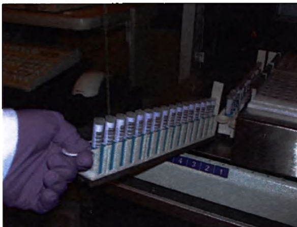
Рисунок 5.40: Загрузка штатива для пробирок с образцами на рабочий стол
