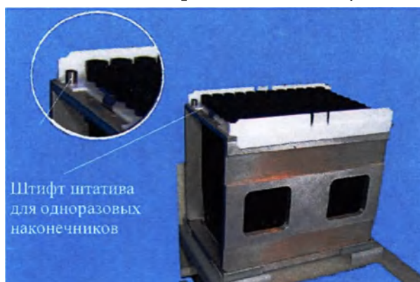
Рисунок 5.179: Штифт штатива для одноразовых наконечников
