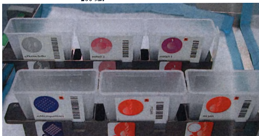
Рисунок 5.190: Промаркированные емкости для реагентов РНК 200 мл
