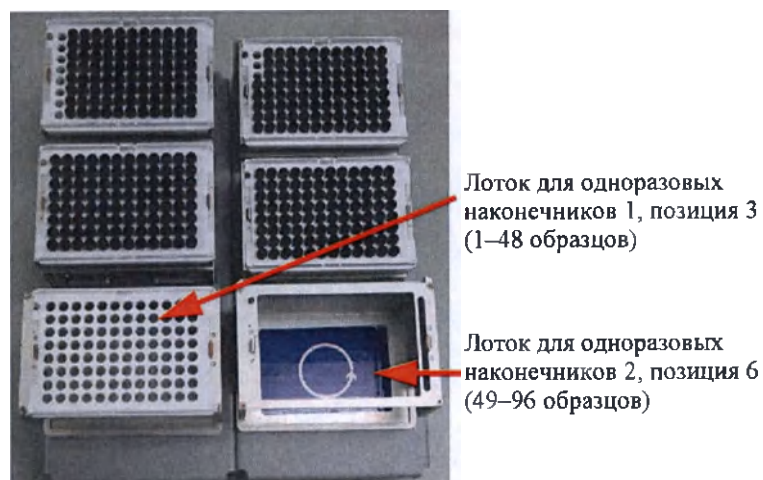
Рисунок 5.184: Штативы для одноразовых наконечников повторного использования на лотке
