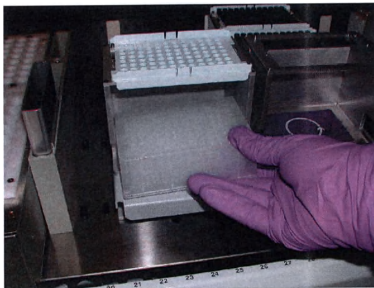
Рисунок 5.66: Штатив для одноразовых наконечников повторного использования: глубоколоночный планшет
