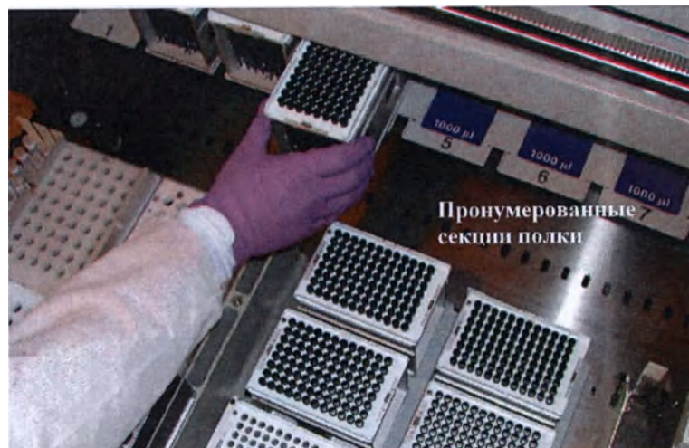
Рисунок 5.180: Загрузка одноразовых наконечников на пронумерованные секции полки, начиная со 2-й и заканчивая 8-й
