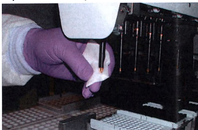
Рисунок 9.8: Очистка одноразовых наконечников
