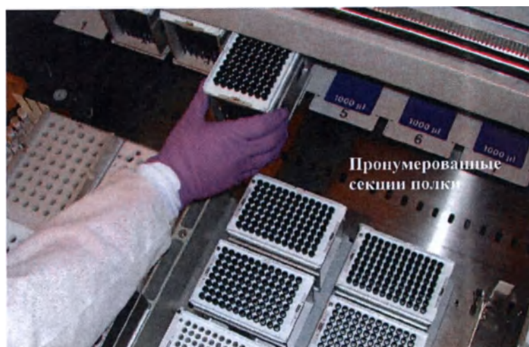
Рисунок 5.61: Загрузка одноразовых наконечников на пронумерованные секции полки, начиная со 2-й и заканчивая 8-й
