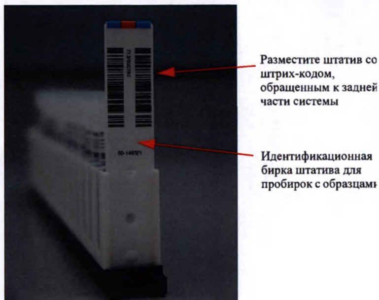
Рисунок 5.167: Штрих-код на идентификационной бирке штатива для пробирок с образцами
