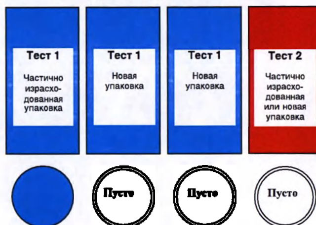
Рисунок 5.154: Размещение пробирок — реагенты пролонгированного использования
