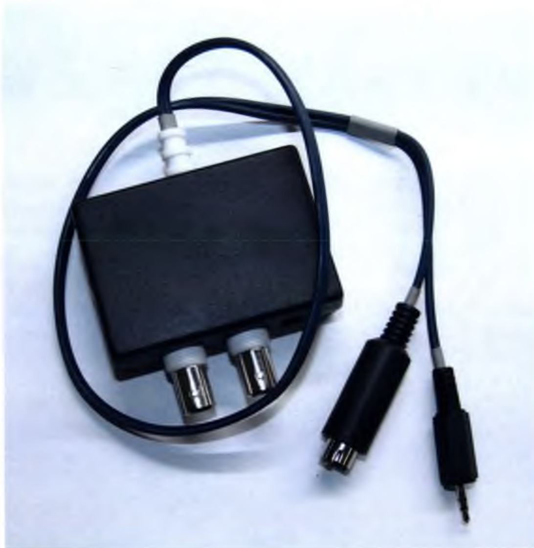
Блок формирования синхроимпульсов «БФСИ-1», NS990201.006-01
