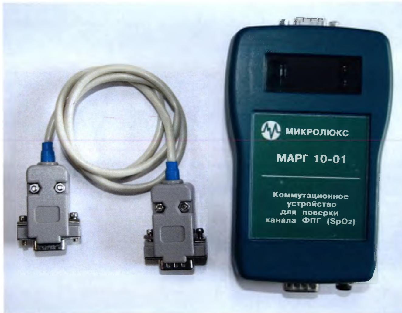
Коммутационное устройство для контроля канала SpO2 МАРГ 10-01 (ООО «Микролюкс», Россия)
