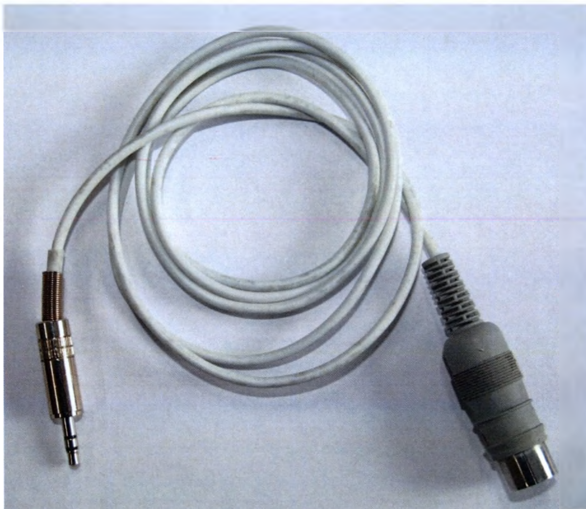
Кабель для проверки параметров слухового стимулятора, NS006103.017
