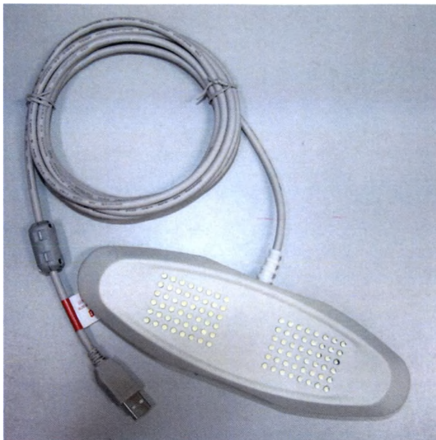
Светодиодный фотостимулятор «ФС-2», NS066999.001 в составе: блок фотостимулятора светодиодного, стойка напольная СН-7
