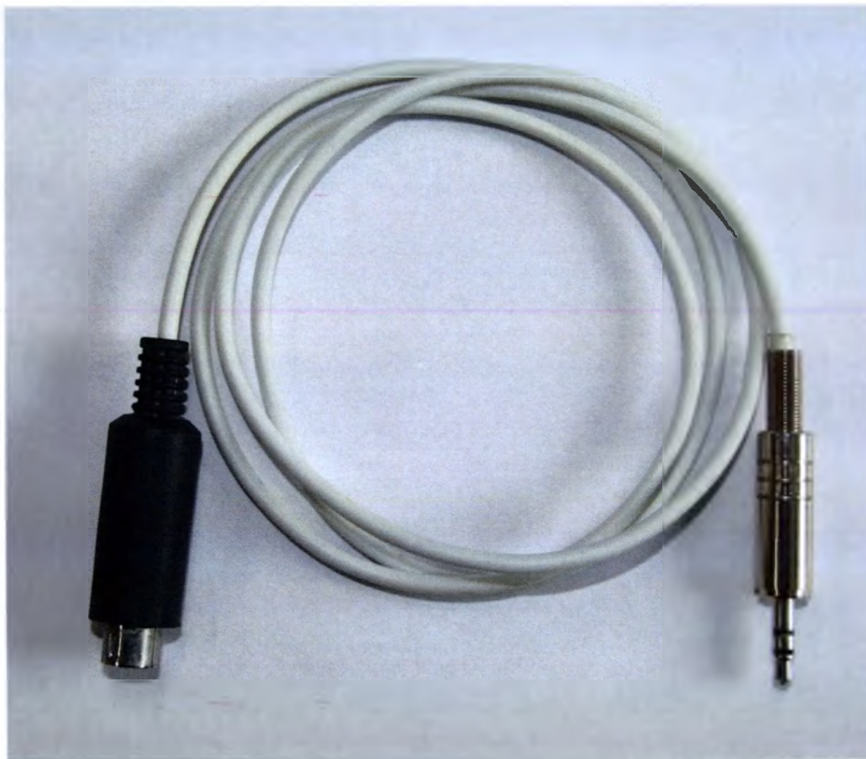
Кабель для проверки параметров фотостимулятора, NS006103.016
