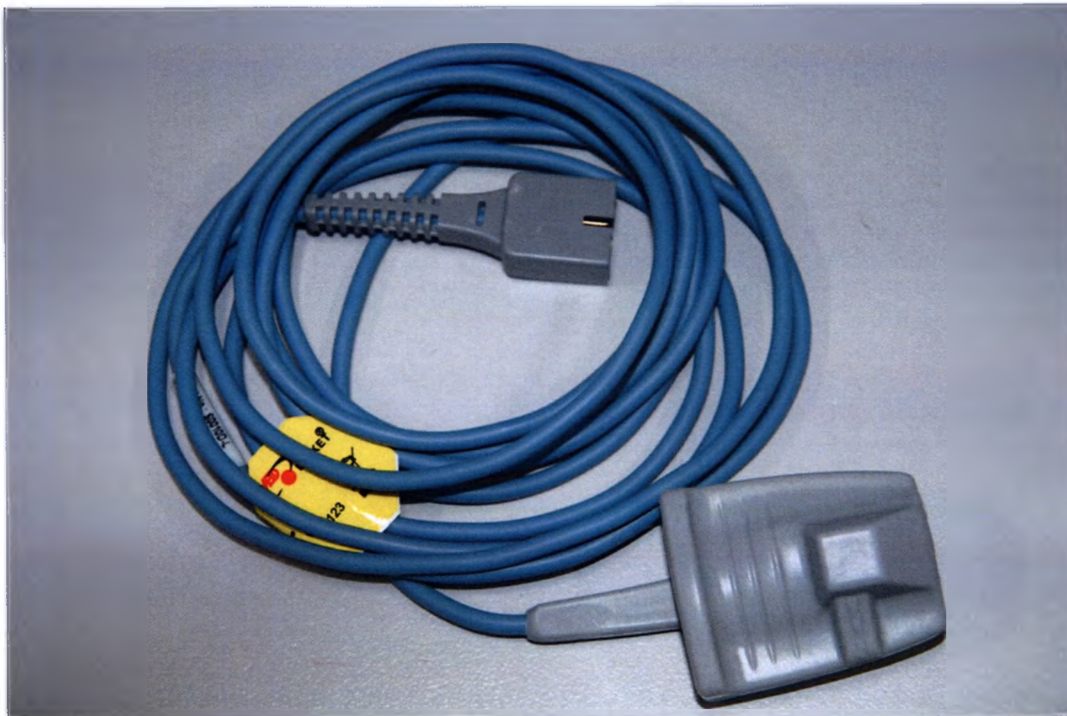
Датчик пульсоксиметрический взрослый (ООО «Микролюкс», Россия) РУ № ФСР 2010/08889 от 03.11.2010
