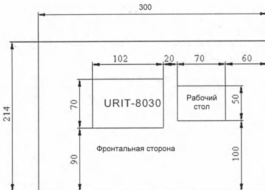
Габариты анализатора: 102x70x112 см (ДxШxВ) Габариты рабочего стола: 70x50x80 см (ДxШxВ), рекомендация
