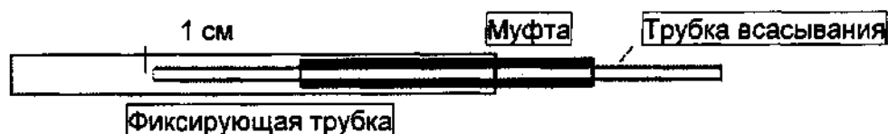
Рис. 6.3.3-1 Соединение трубки с проточной кюветой
