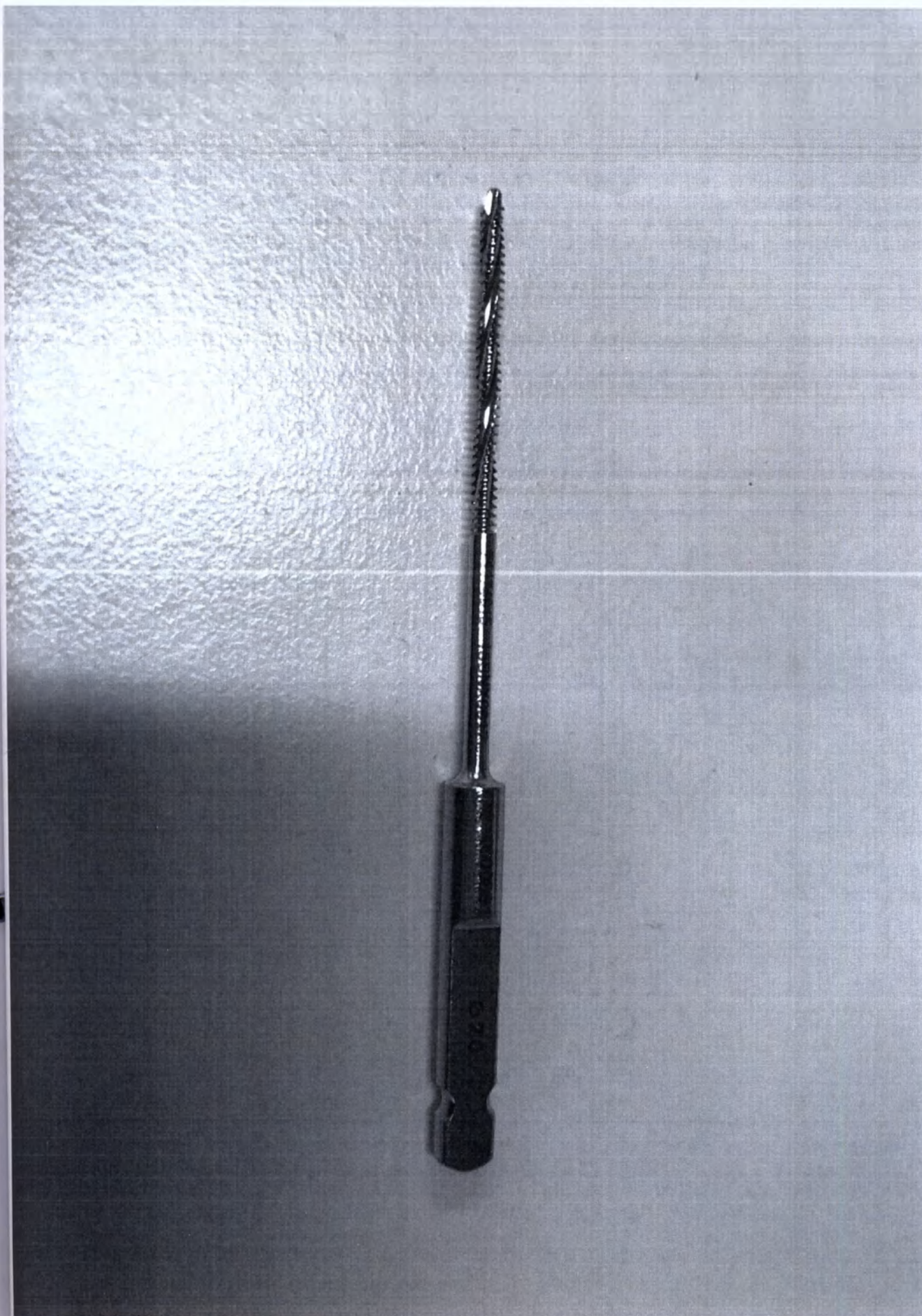
Фотографическое изображение №27: метчик 2.0мм с соединением АО, метчик 2.4мм с соединением АО. На примере: метчик 2.0мм с соединением АО
