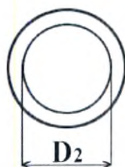
Рисунок 18.1 – обозначение внутреннего диаметра металлической трубки канюли
