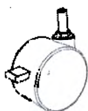
6 — переднее колесо со стопором
