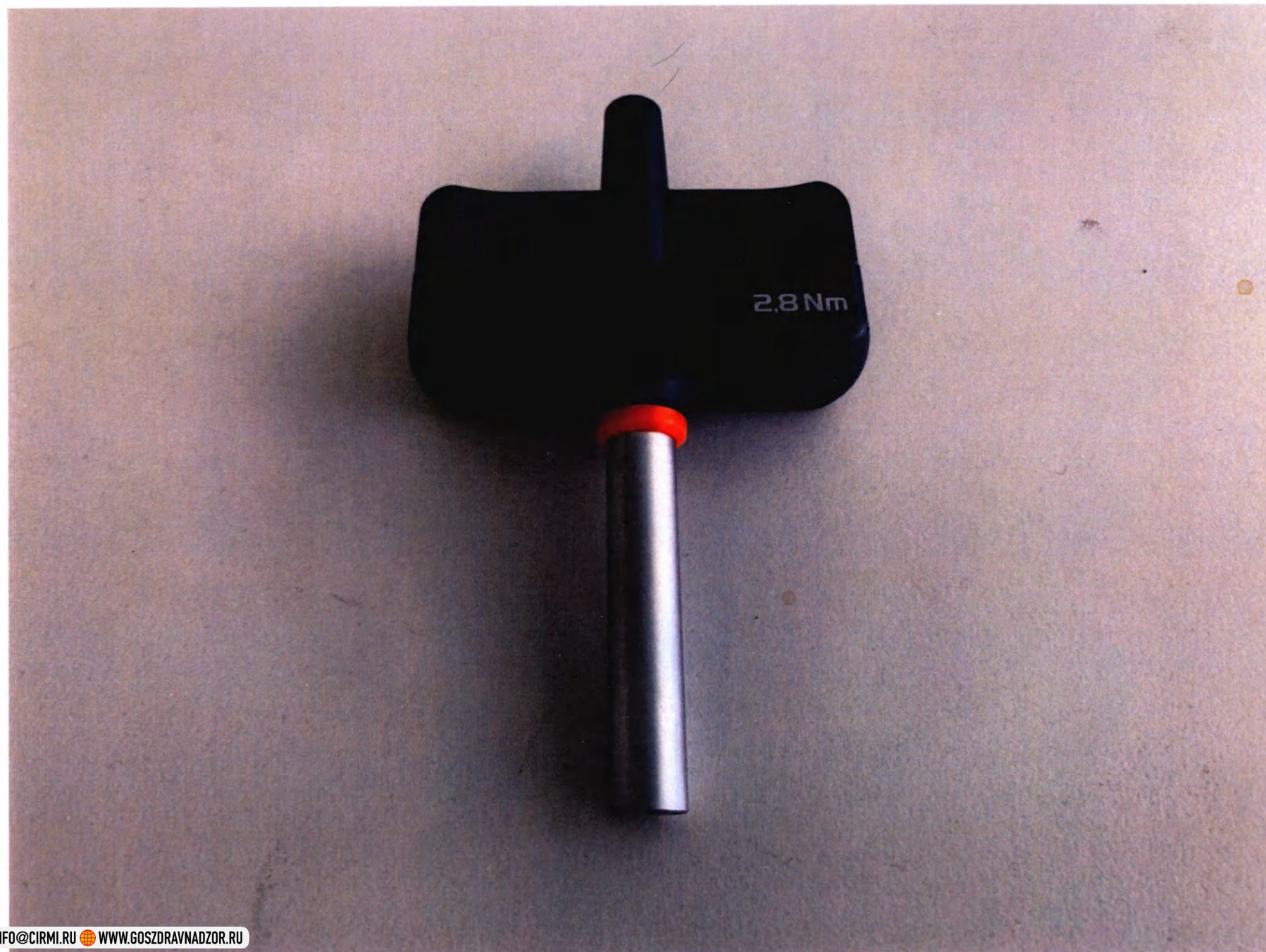
8. Ключ динамометрический, 2.8 Нм
