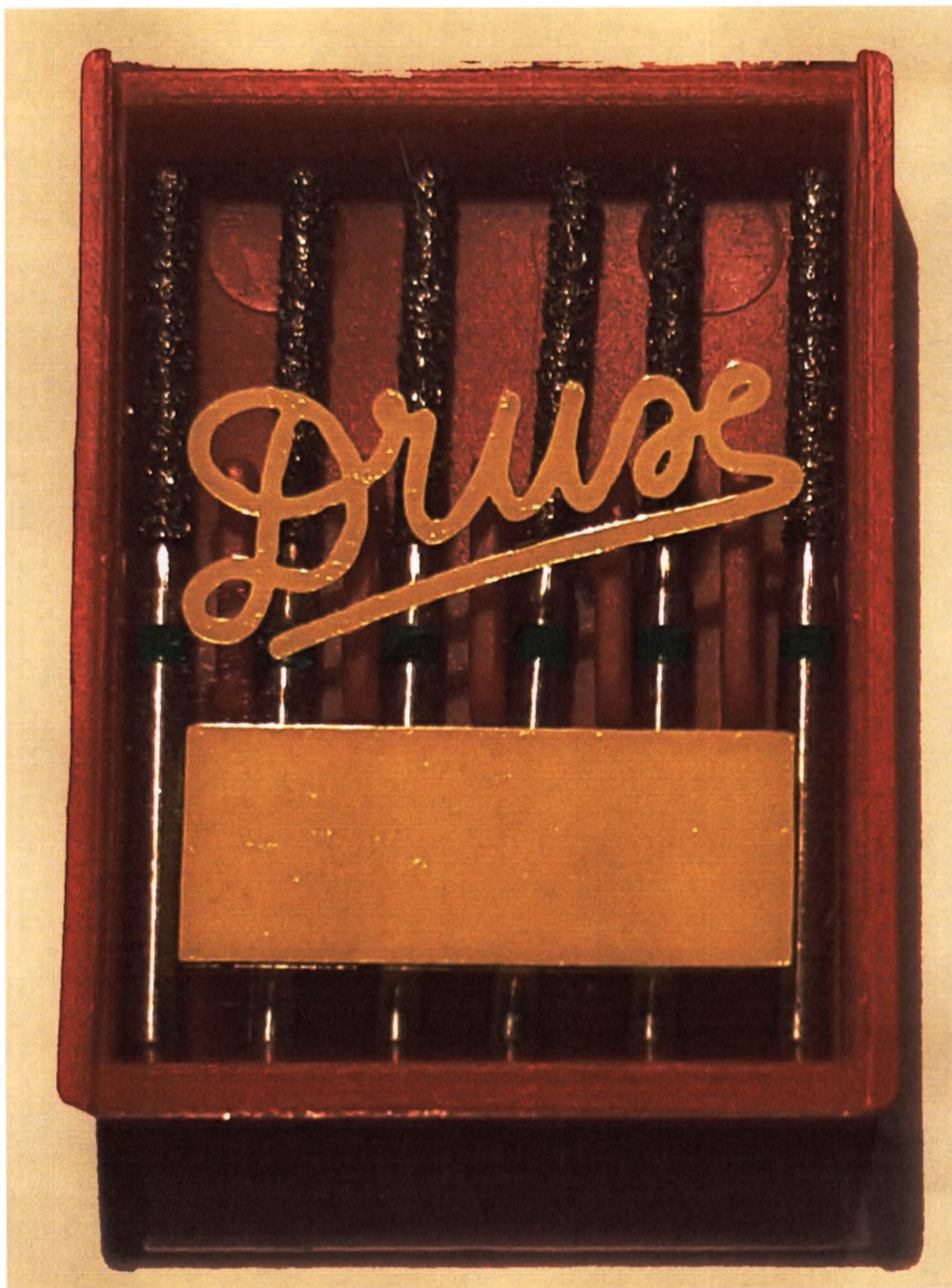
Бор с алмазным покрытием с гальваническим соединением вращающийся, вариант исполнения: 837LKR, диаметр рабочей части: 014, длина рабочей части 10,0, тип хвостовика: FG цвет: зеленый (цветовой код 6), в пластиковой упаковке по 6 шт.
