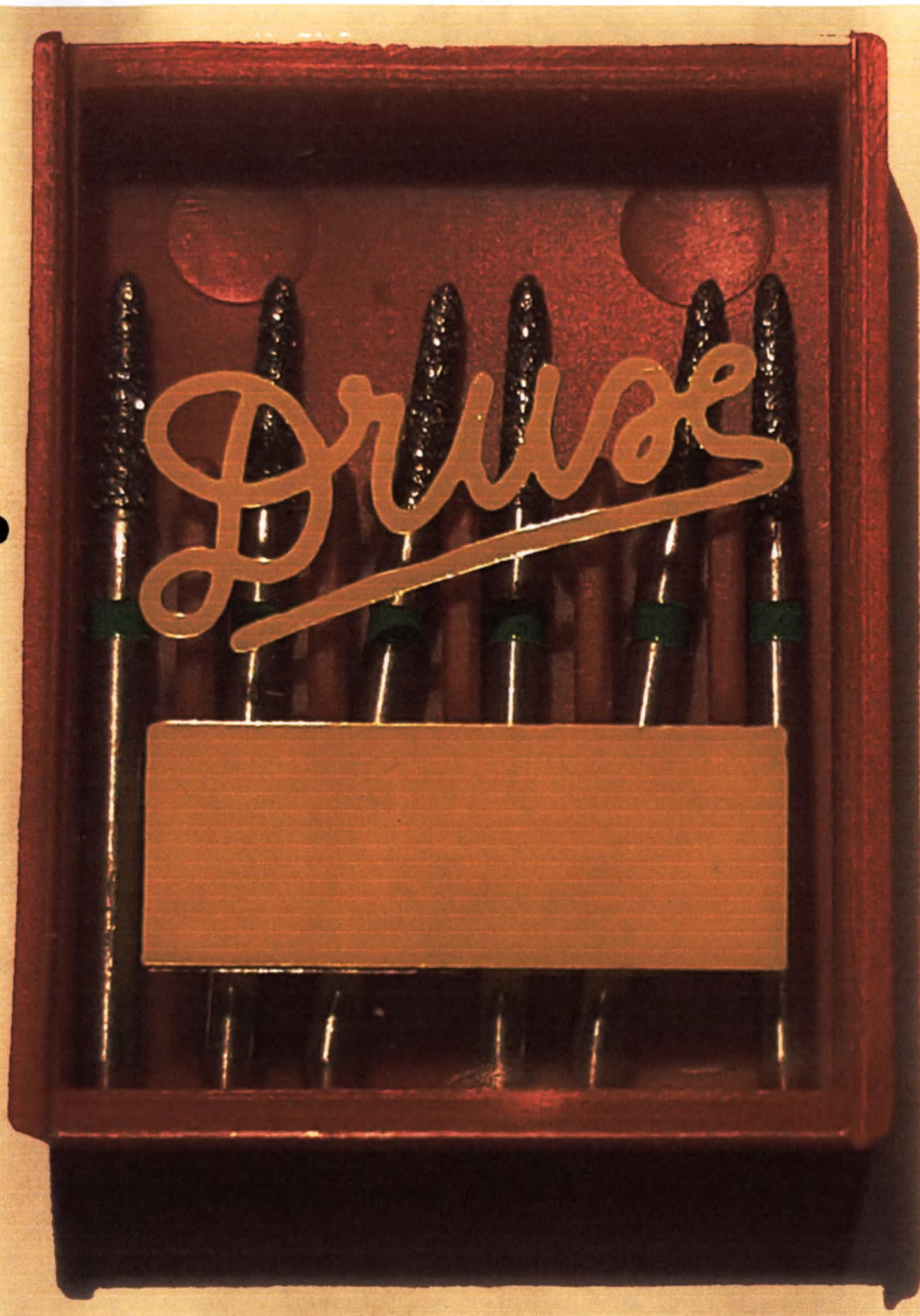
Бор с алмазным покрытием с гальваническим соединением вращающийся, вариант исполнения: 869, диаметр рабочей части: 014, длина рабочей части 6,0, тип хвостовика: FG цвет: зеленый (цветовой код 6), в пластиковой упаковке по 6 шт.
